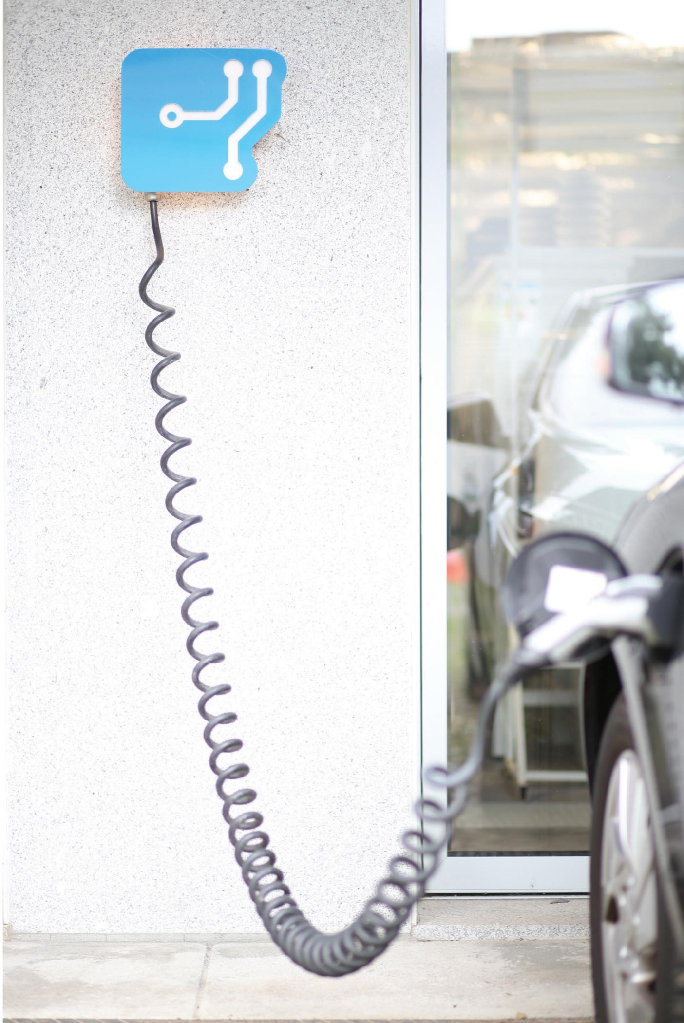
ligado à rede, poderá carregar de forma controlada ao operar em modo G2V (grid-to-vehicle), assim como dar suporte à rede ou até à residência onde esteja ligado, ao operar em modo V2G (vehicle-to-grid) ou V2H (vehicle-to-home) (MONTEIRO, 2016) (GOUVEIA, 2013).
