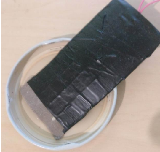
Figura 43: Teste ao sensor de vazamento
