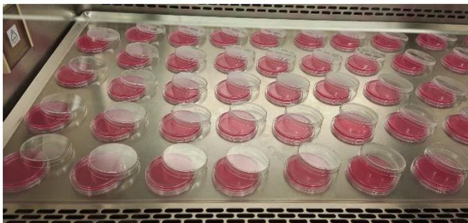
**Figura 18:** Placas com meio de cultura na fase de espera de desaparecimento de condensação.
