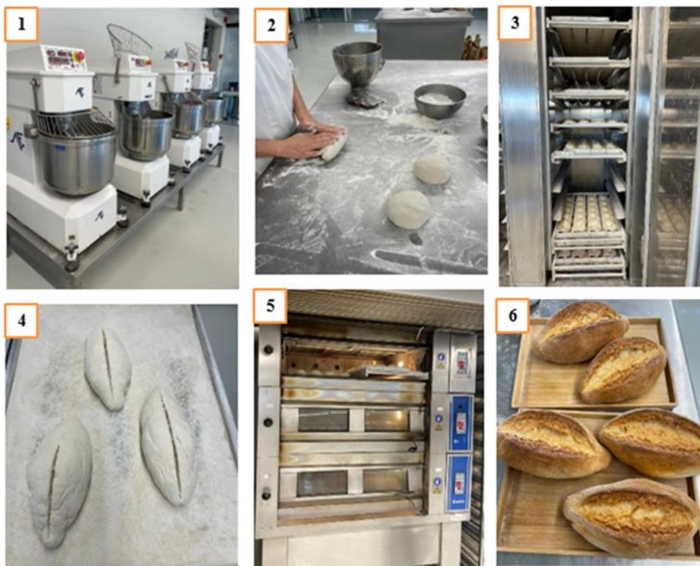
Figura 4 – Etapas da produção manual: (1) Amassadeiras industriais onde se processa a amassadura (2) Moldagem da massa (3) Estufa onde se realiza o processo de fermentação (4) Massa moldada já fermentada (5) Forno industrial onde é cozido o pão (6) Pão obtido após a cozedura.
