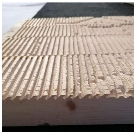
Figura 67 Base produzida em madeira com os cortes inclinados
