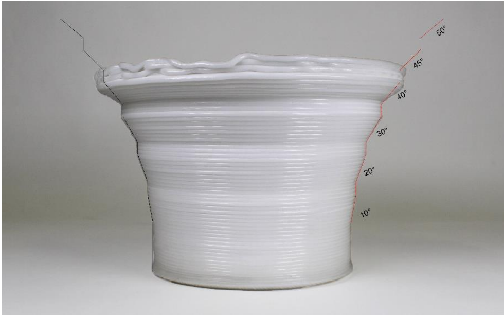
Figura 74 Resultado do teste da peça com diferentes ângulos como a marcação do resultado esperado
