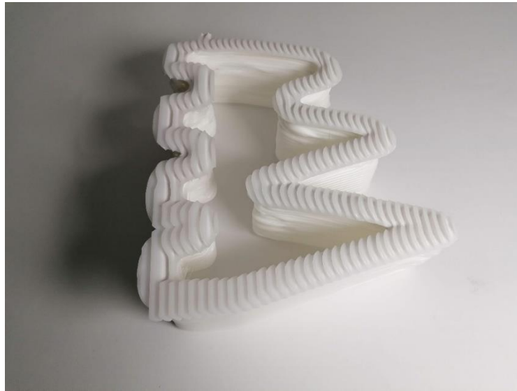
Figura 71 Efeito da base com cortes inclinados na base da peça produzida
