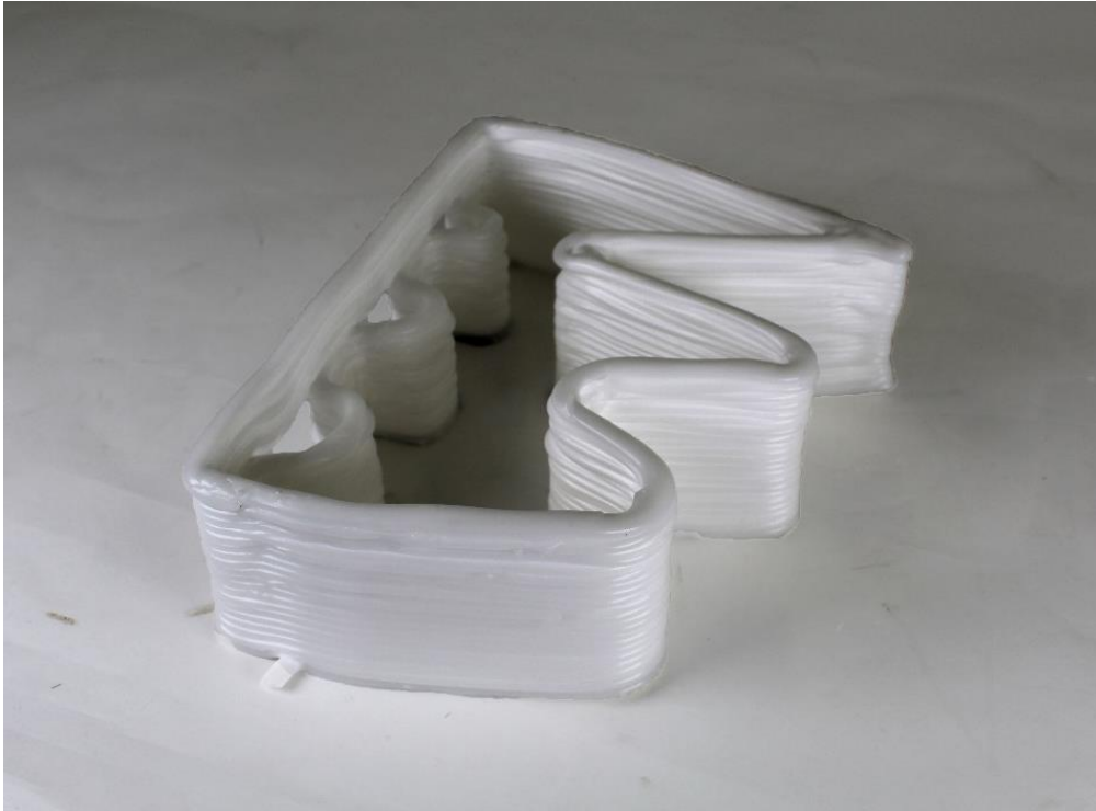
Figura 79 Peça padrão para a análise da curvatura dos cantos e pontes
