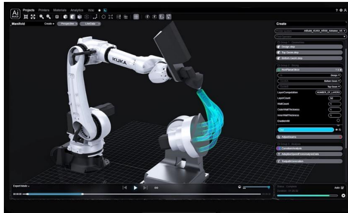
Figura 15 Visualização do ambiente de trabalho do software AiSync (AiBuild, 2023)
