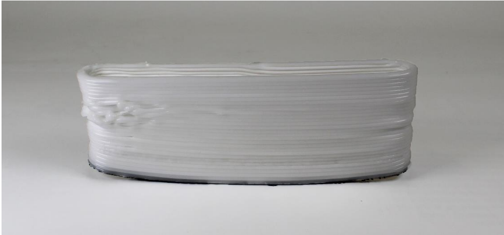
Figura 86 Forma inicial para o teste de diferentes perímetros de camada
