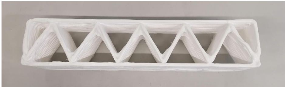
Figura 91 Teste inicial de preenchimento da forma
