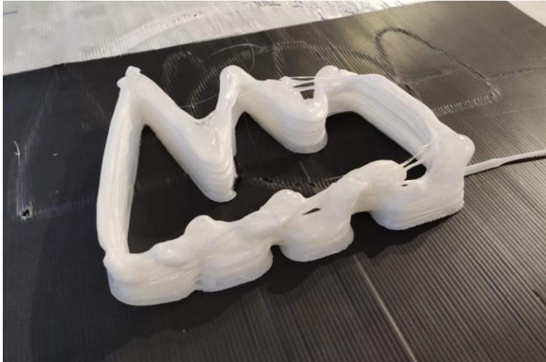
Figura 77 Teste inicial da peça com cantos e pontes
