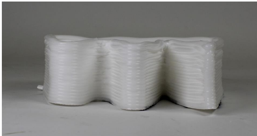
Figura 81 Peça padrão para a análise da curvatura dos cantos e pontes (vista de frente com os cantos)
