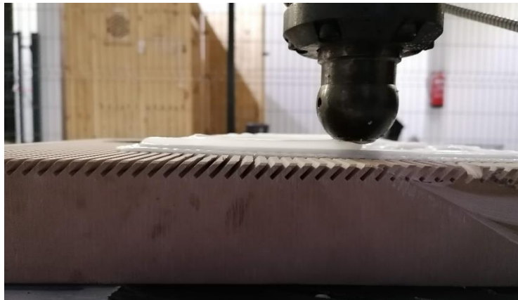
Figura 69 Impressão sobre a base de poliuretano com cortes inclinados
