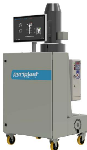
Figura 12 Sistema de controlo e alimentação da extrusora (Periplast, 2023)
