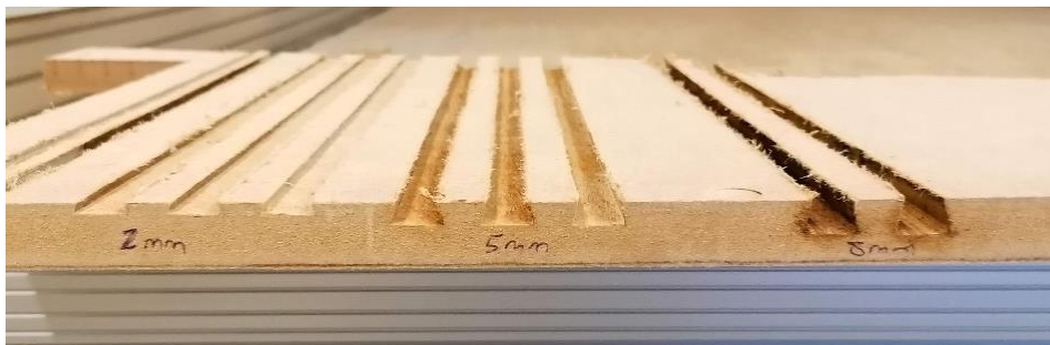
Figura 63 Teste de profundidade para o corte em cauda de andorinha
