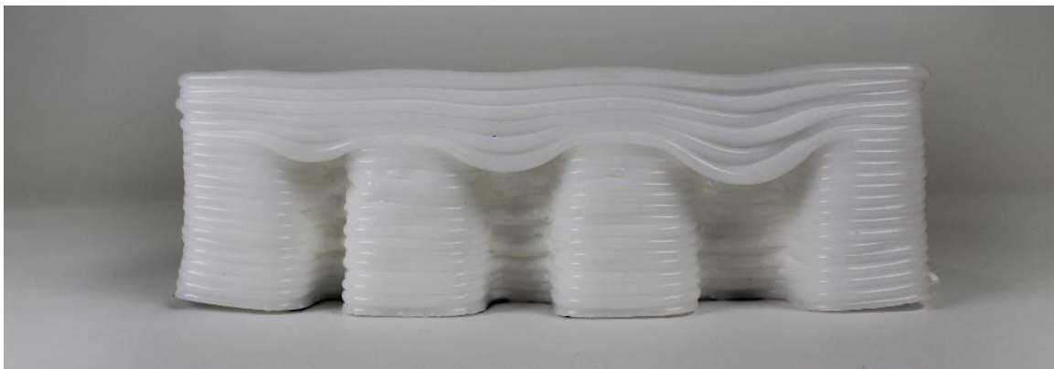
Figura 83 Vista traseira da peça padrão com o estudo das pontes com uma altura de 20 milímetros
