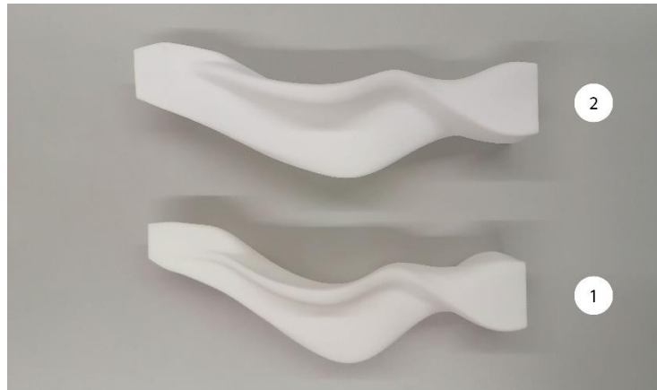
Figura 95 Modelos à escala 1/100 produzidos em SLS
