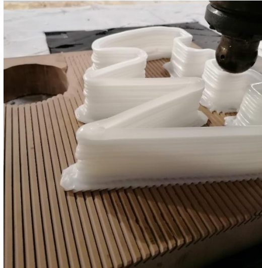
Figura 70 Impressão de uma geometria irregular sobre a base de poliuretano com cortes inclinados
