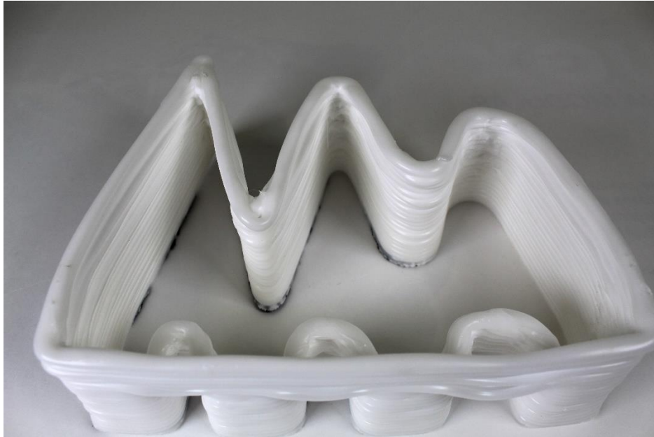
Figura 80 Peça padrão para a análise da curvatura dos cantos e pontes (vista interior)
