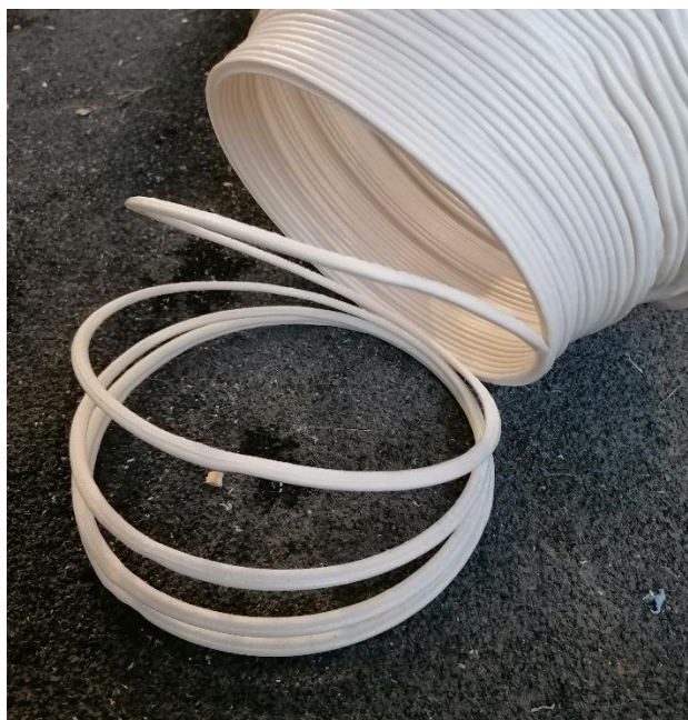
Figura 85 Delaminação nas camadas iniciais de uma peça
