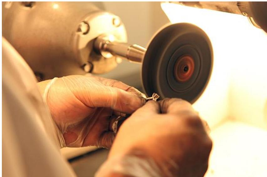
Figura 6 - Polimento de uma peça, fonte:[139]
