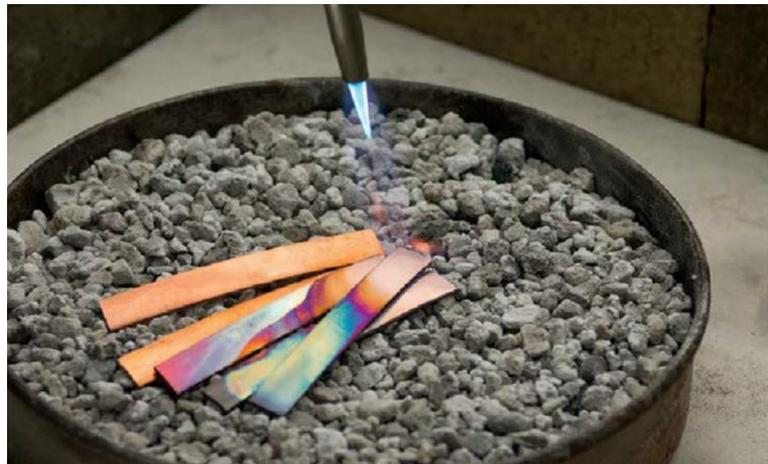
Figura 4 - Metal sendo recosido, fonte:[137]
