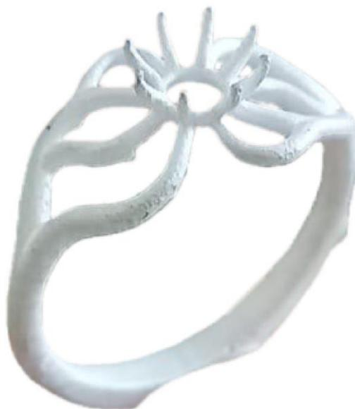
Figura 146 - Anel\_Pedra com argola após a fundição
