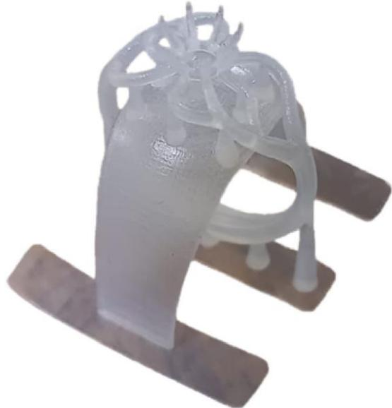
Figura 138 - Impressão do Anel\_Pedra com argola
