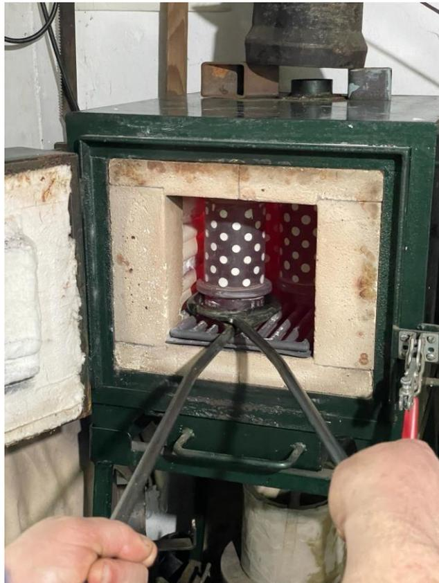
Figura 142 - Colocação do molde no forno
