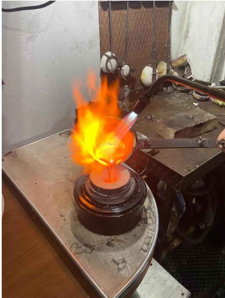
Figura 145 - Vazamento do metal no molde
