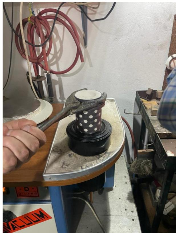
Figura 144 - Colocação do molde no vácuo
