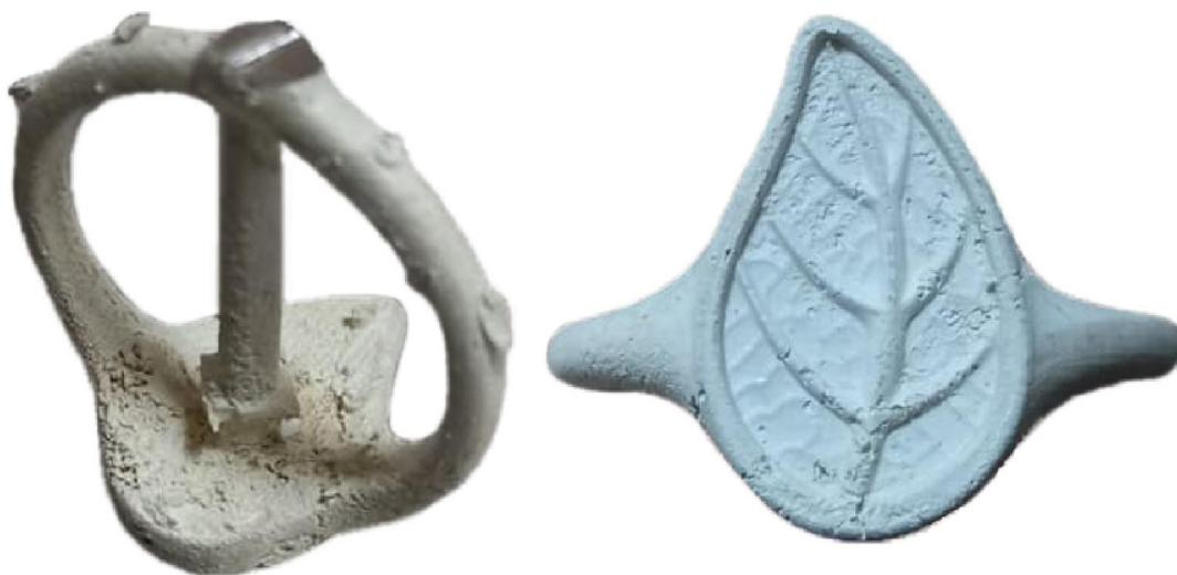
Figura 151 - Novos Anel\_Esmalte (desenhos salientes) após fundição
