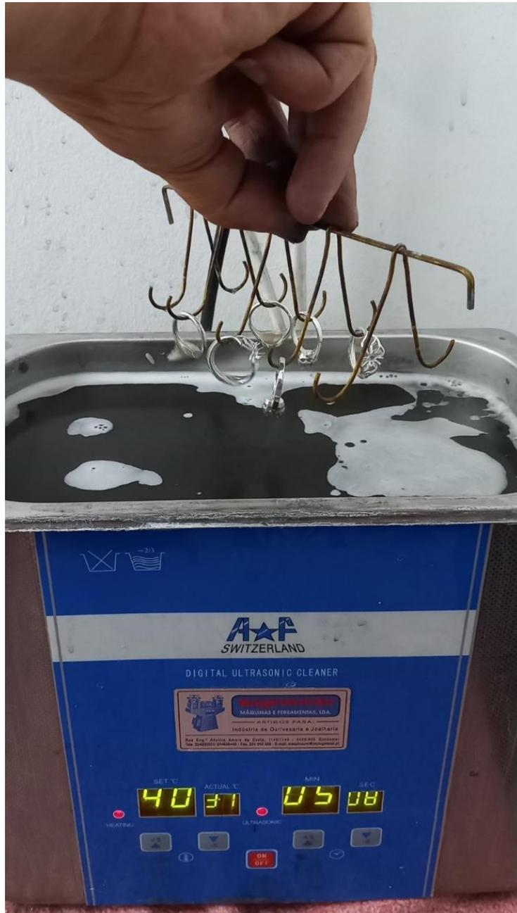
Figura 157 - Utilização de limpeza ultra-sónica nos anéis
