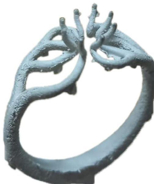
Figura 147 - Anel\_Pedra sem argola após a fundição
