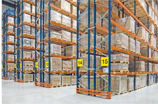
Figura 3 - Rack convencional (Mecalux (a), 2023).
