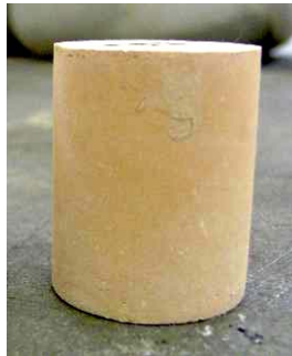
Figura 8 –Provete de solo/Metacaulino/Cal compactado
