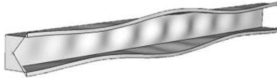
Figura 2.21 - Interação de modos de Instabilidade [17]
