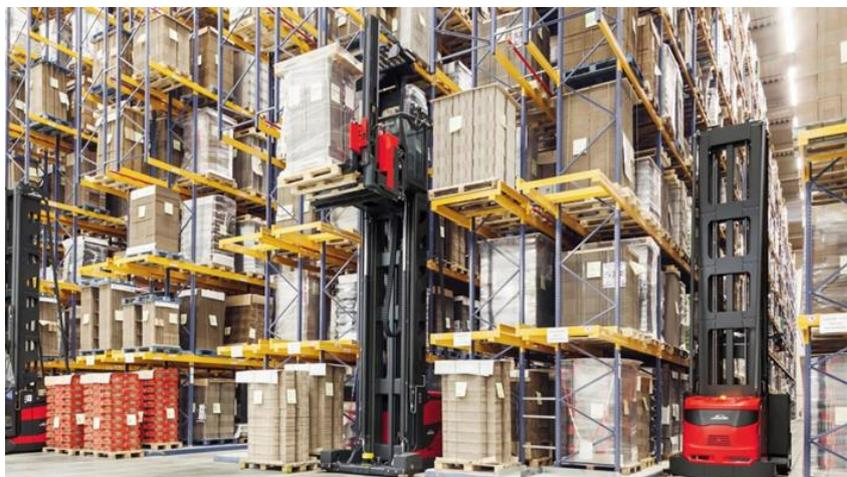
Figura 2.5 - Sistema de Armazenamento "Estreito" [6]
