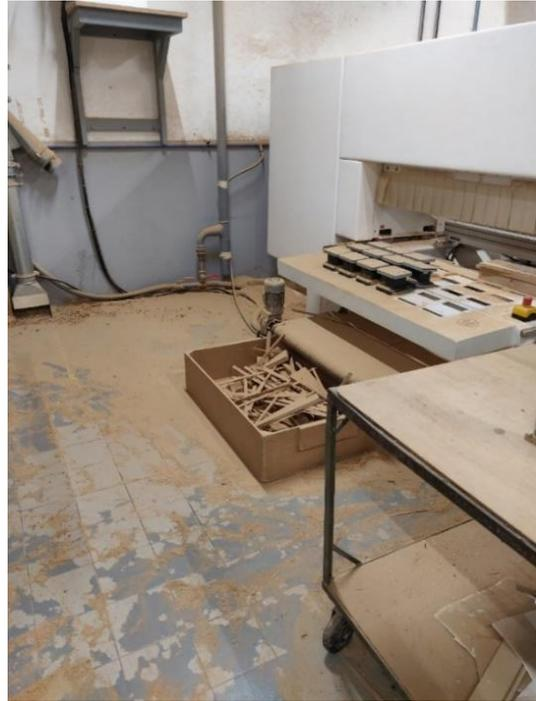
*Figura 48 - Acumulação de lixo e pó entre a CNC n°1 e a multifuradora*
