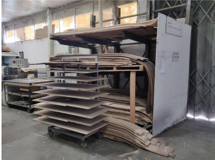
*Figura 15 - Armazenamento de matéria-prima para corte e cosedura de folha*
