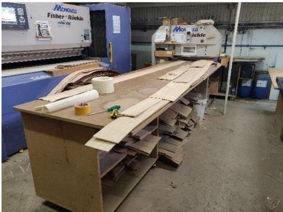
*Figura 16 - Guilhotinas e estação de corte de folha*
