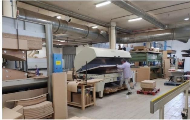
*Figura 37 - Prensa hidráulica e prensa de membrana*
