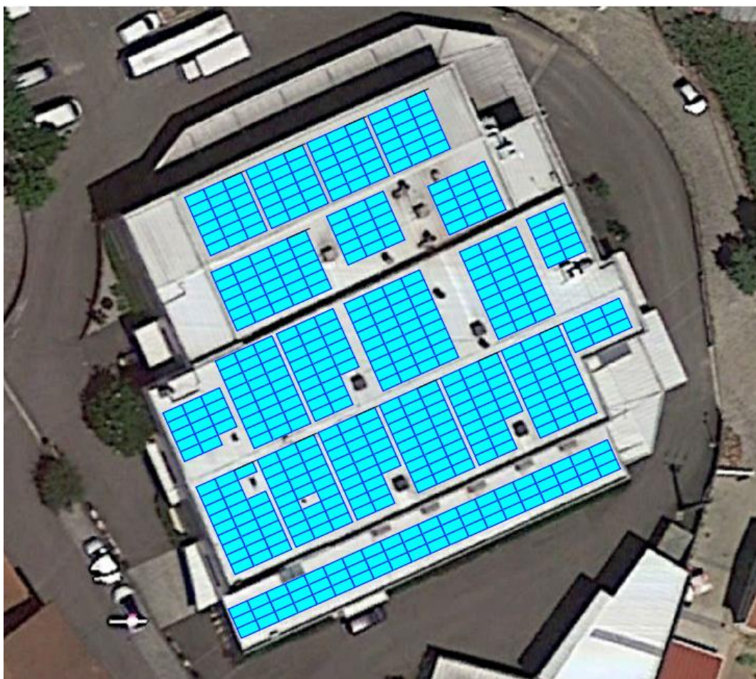
Figura 5.11 - Possível esquema de disposição dos módulos PV no telhado da empresa C. (Imagem fornecida pela empresa DAPE)
