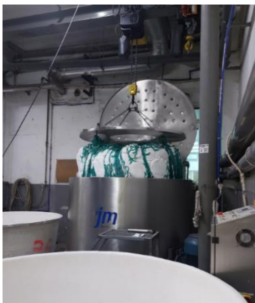
Figura 23 - Hidro com cordas em mau estado
