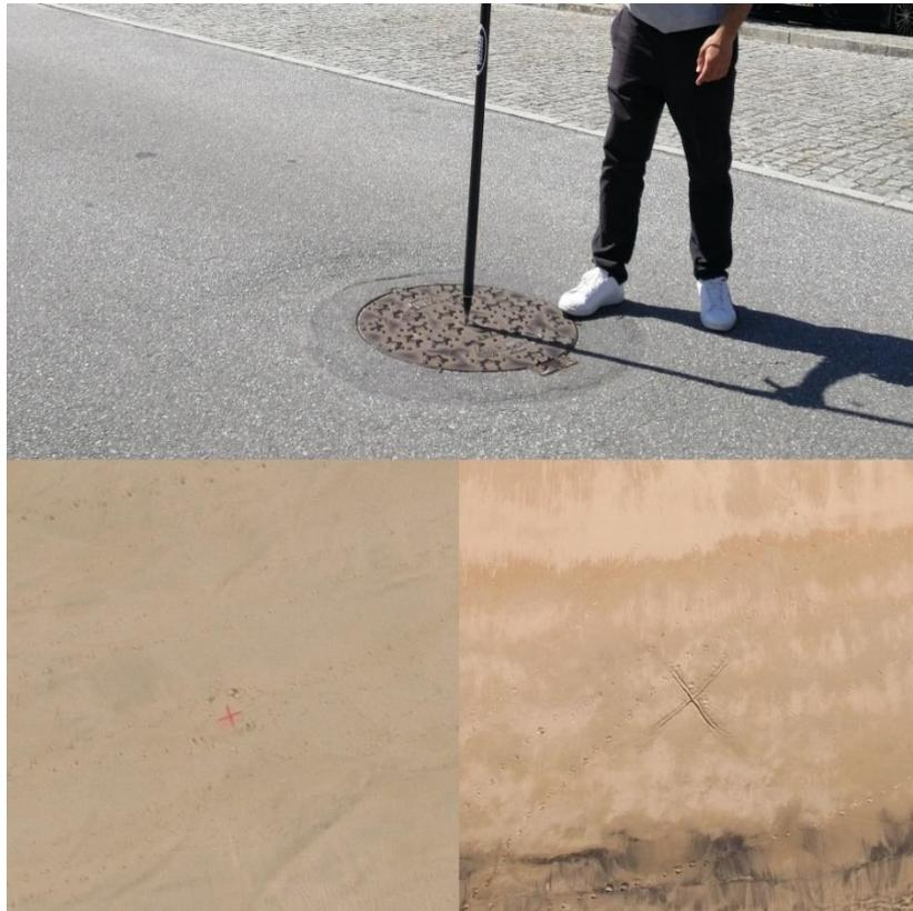
**Figura III - 4:** Exemplos de pontos de controlo no terreno.
