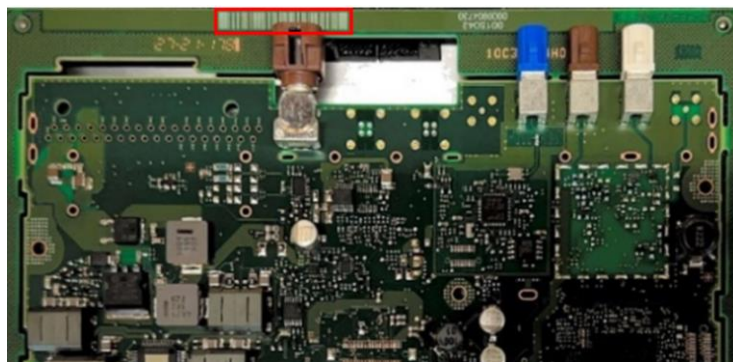
Figura 39 - Exemplo de um código de barras na PCB.
