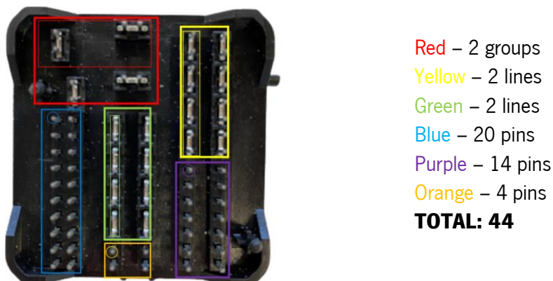
Figura 46 - Componente dividido em secções e número de pinos por secção.
