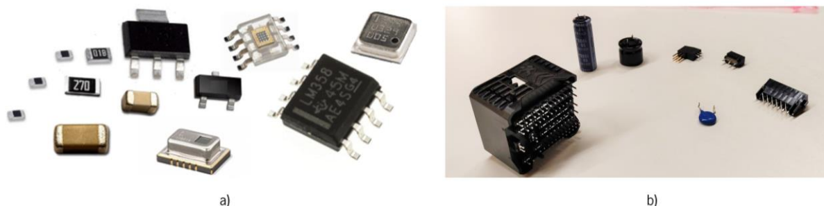
Figura 1 - Conjunto de componentes: a) SMD [1]; e b) PTH.
