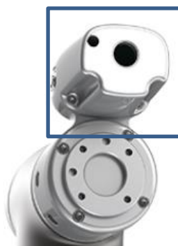
Figura 23 - Sistema de visão interno do robô TM5-700 [20].
