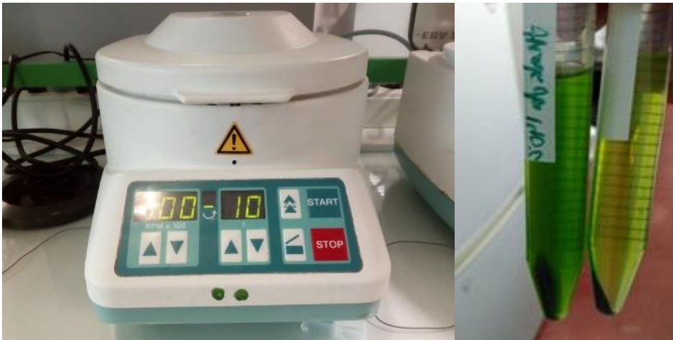
Figura 8 - Microcentrifugadora utilizada para separação das fases líquidas e sólidas das amostras de cada tratamento à esquerda e demonstração do efeito de centrifugação em amostras de microalgas à direita.
