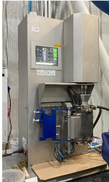
Figura 12 - Micro-extrusora duplo fuso (Xplore) co-rotativa
