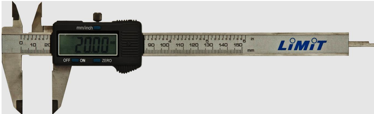
Paquímetro de amplitude e alcance iguais a 150 mm
