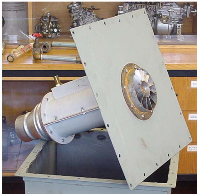
Figura B. 4: Imagem de conjunto do sistema de geração de rotação e do tubo de alojamento do atomizador efervescente.
