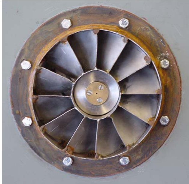
Figura B. 3: Aspecto do gerador de rotação de ar de combustão utilizado na fornalha provisória.
