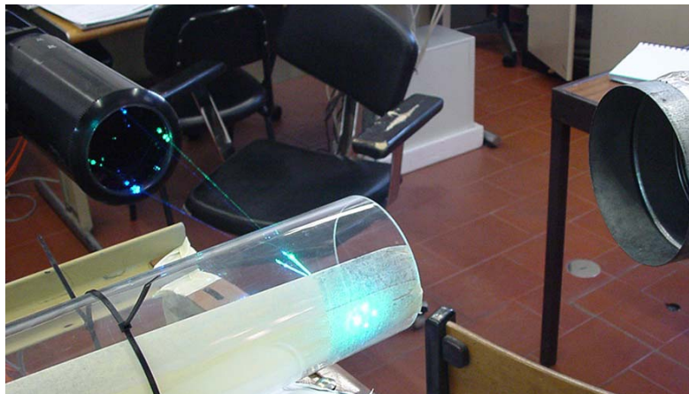
Figura E. 6: Utilização do LDA para determinação do perfil de velocidades no tubo de acrílico
