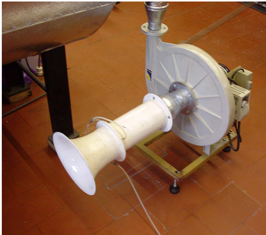
Figura 3.9: Aspecto do ventilador e tubeira para medição do caudal de ar secundário
