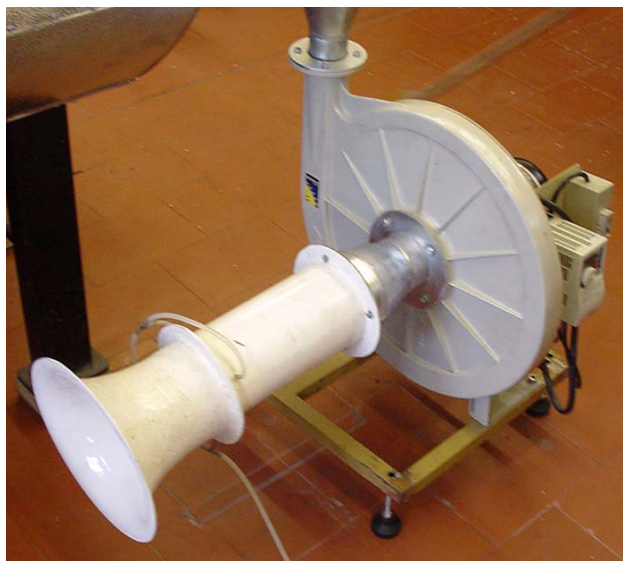
Figura E. 3: Aspecto da tubeira de entrada de ar, em fibra de vidro
