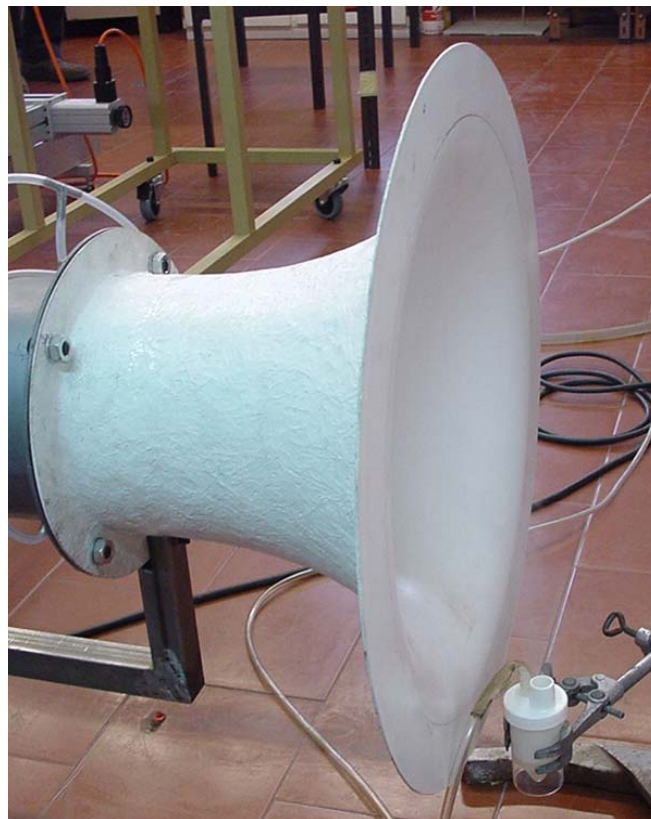
Figura E. 7: Pormenor de injeção de óleo de silicone pulverizado, no escoamento de ar, durante os ensaios de calibração da tubeira
