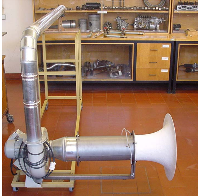
Figura E. 5: Instalação para calibração da tubeira de entrada de ar secundário
