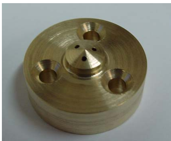
Figura 5.15: Pormenor do atomizador com três orifícios de saída (Atomizador E).
