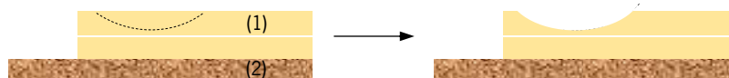
Figura 47 - Esquema representativo do corte curvo efetuado para a construção da estrutura almofadada: (1) – placas de espuma; (2) – placa de madeira prensada.
