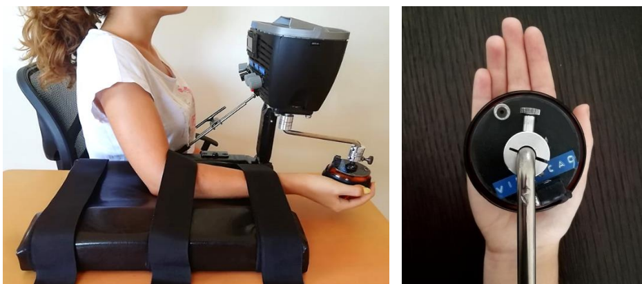
Figura 26 - Posicionamento do dispositivo, do antebraço e da mão do paciente no movimento de DC-DR.
