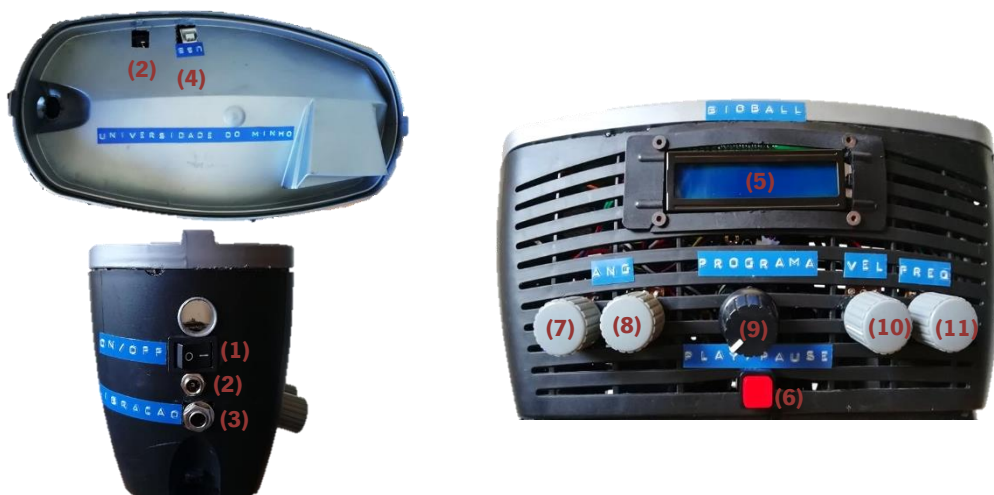
Figura 21 - Diferentes vistas do controlador do BioBall: (1) - Botão on/off ; (2) - Entrada para alimentação; (3) - Entrada para sistema de vibração; (4) - Entrada USB; (5) - LCD; (6) - Botão de emergência, play/pause ; (7) - Ângulo A1; (8) - Ângulo A2; (9) - Controlador do tipo de programa; (10) - Controlador de velocidade; (11) - Controlador de frequência.
