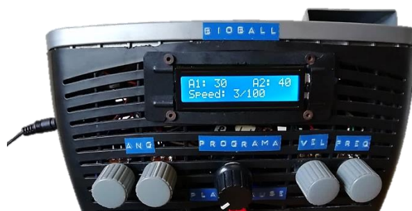
Figura 28 - Exemplo de apresentação do LCD durante a realização de um exercício no programa do “Exercício Passivo” em que se selecionou A1 = 30^\circ , A2 = 40^\circ e v = 3/100 .
