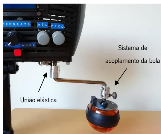
Figura 20 - Acoplamento da bola à barra excêntrica em “S” e desta última ao eixo do motor.
