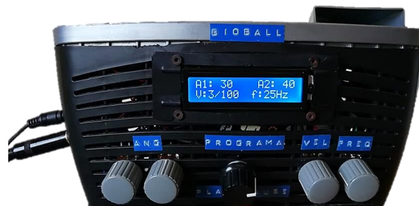
Figura 40 - Exemplo de apresentação do LCD durante a realização de um exercício no programa do “Exercício Misto” em que se selecionou A1 = 30^\circ , A2 = 40^\circ , v = 3/100 e f = 25 Hz.
