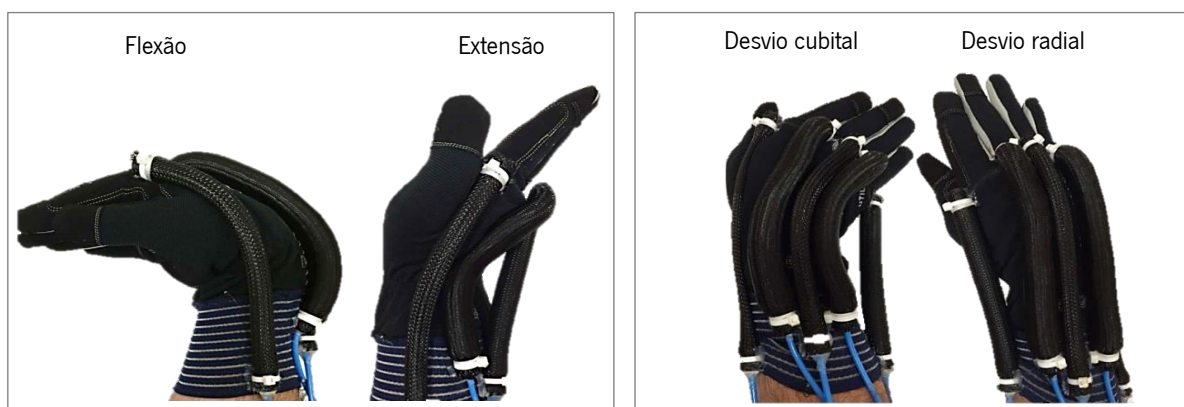
Figura 15 - Movimentos de reabilitação do exoesqueleto desenvolvido. Adaptado de [60].
