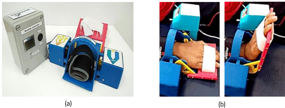
Figura 16 - Protótipo do WRist-T obtido por impressão 3D: (a) estrutura do dispositivo; (b) exemplo do movimento do punho num exercício de extensão. Adaptado de [61].
