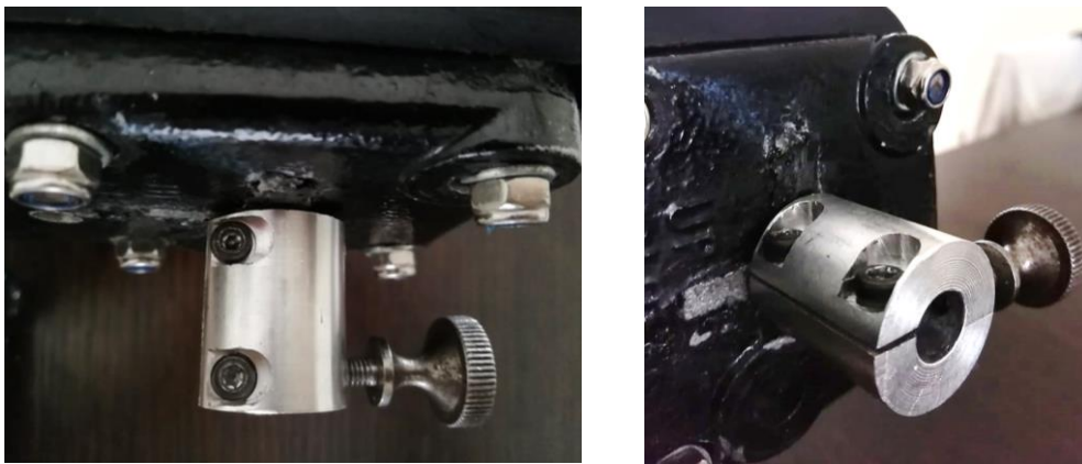
Figura 50 – Peça de alumínio construída para o acoplamento rígido e manipulador para acoplar ou desacoplar a barra excêntrica.
