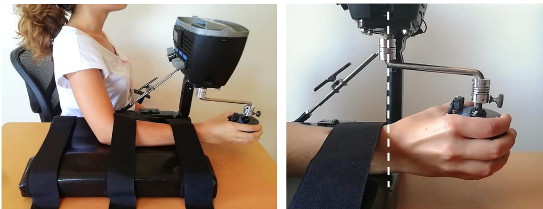
Figura 25 - Posicionamento do dispositivo, do antebraço e da mão do paciente no movimento de FLEX-EXT. A linha a tracejado indica como se deve colocar o punho alinhado com o eixo do motor.
