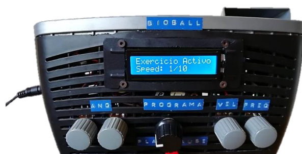
Figura 29 - Exemplo de apresentação do LCD durante a realização de um exercício no programa do “Exercício Ativo” em que se selecionou v = 1/10 .
