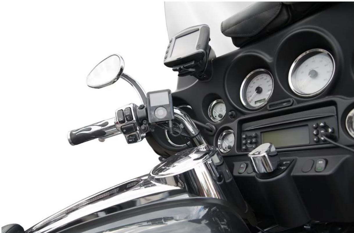
Figura 35. Exemplo de diferentes tipos de controles em PTW (Ricardo Lins, 2023).
