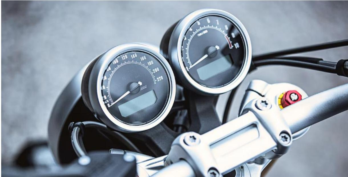
Figura 33. Exemplo de indicador de velocidade e Rpm (Master 1305, 2023).
