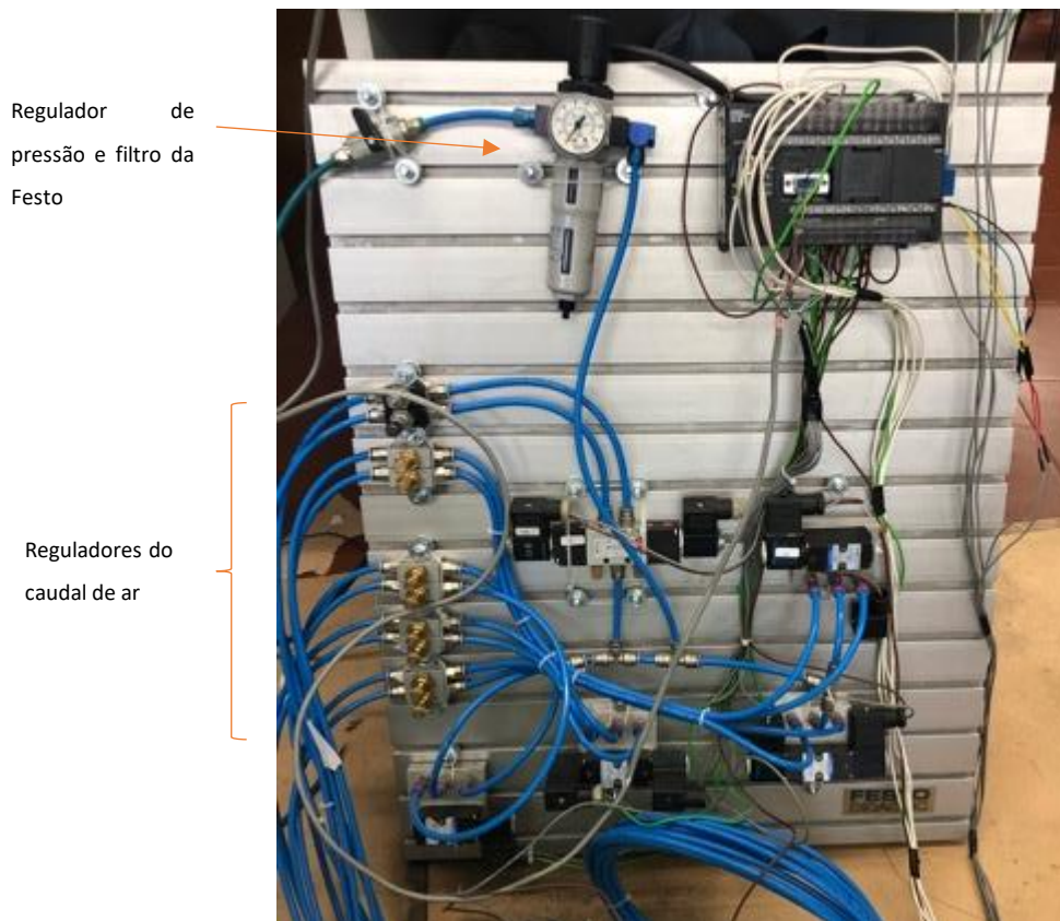
Figura 4.5 - Sistema pneumático implementado no dispositivo.
