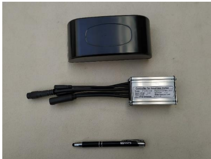
Figura 5.21 – Controlador original e respetiva caixa de armazenamento.
