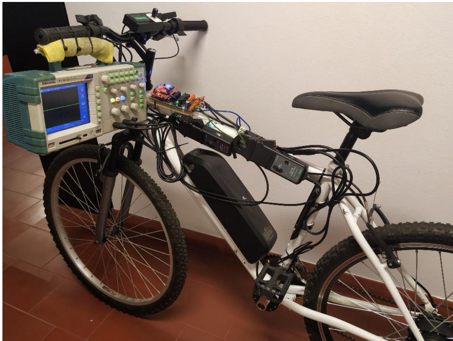
Figura 6.7 – Montagem realizada para obtenção de resultados em carga.
