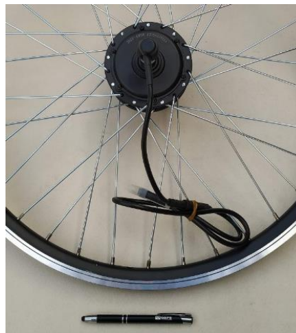
Figura 5.7 – Motor utilizado já instalado na roda.
