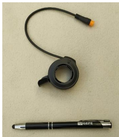
Figura 5.15 – Acelerador convertido a botão de ajuda ao arranque.
