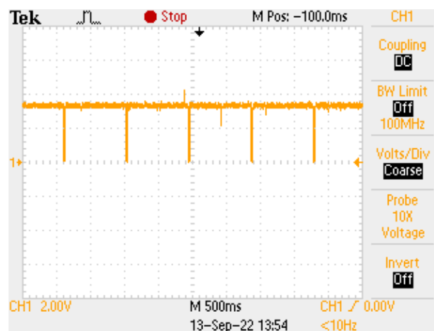
Figura 6.10 – Sinal de saída do sensor de velocidade (2 V/div.).
