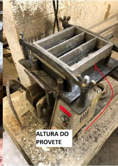
Figura 21 - Preparação da argamassa    Figura 22 - Ensaio do espalhamento    Figura 23 - Altura do provete e máquina de compactação
