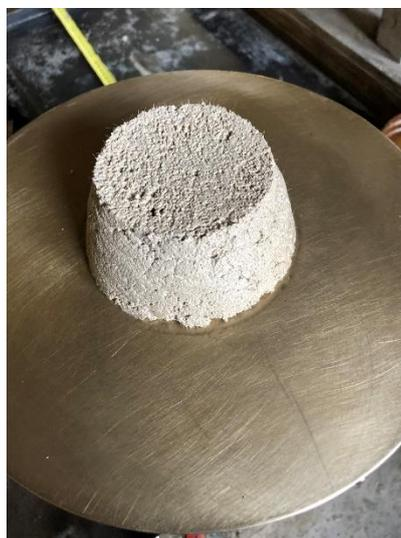
*Figura 19 - Após a retirada do molde*
