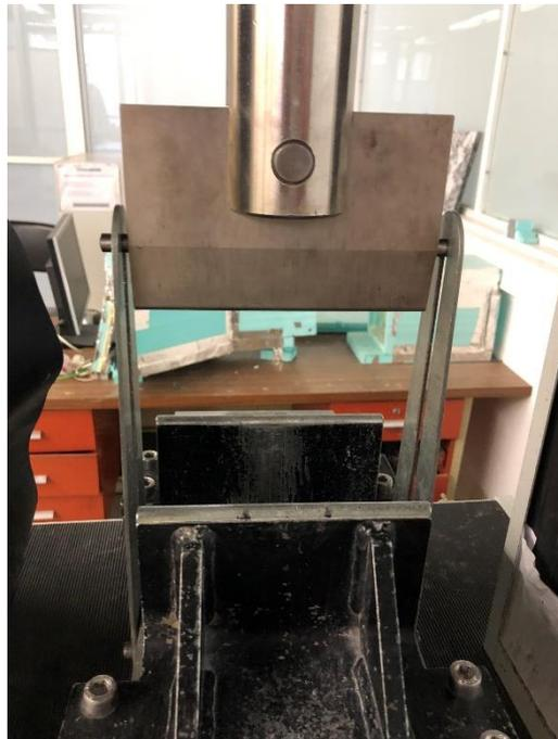
*Figura 31 - Sistema usado para Flexão*
