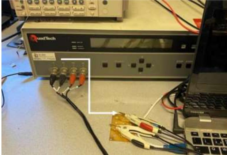
Figura 3.4 – Quadtech (1929 Precision LCR Meter), usado para medição de propriedades dielétricas de uma determinada amostra.
