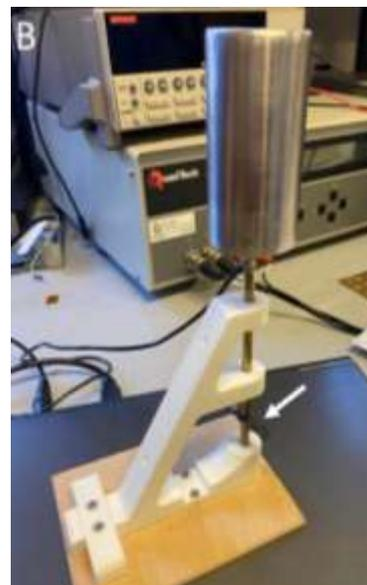
Figura 3.5 – Máscara utilizada para deposição de elétrodos de ouro em volume (A); Suporte utilizado para a deposição dos elétrodos de ouro (B).
