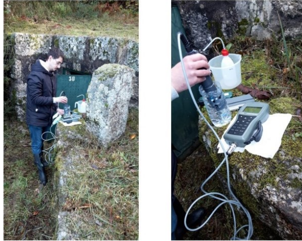
Figura 38 - Medição “in situ” dos parâmetros físico químicos da água subterrânea
