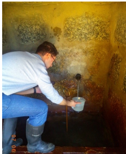
Figura 39- Medição do caudal durante a segunda campanha de campo.
