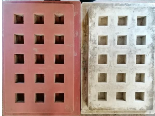
Figura 42 - Moldes para os provetes cúbicos com 20 mm de aresta.
