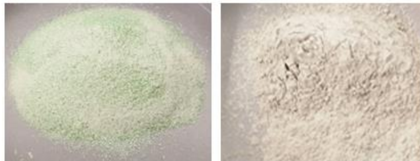
Figura 30 - Resultado da peneiração após 40 ciclos na máquina de Los Angeles.
