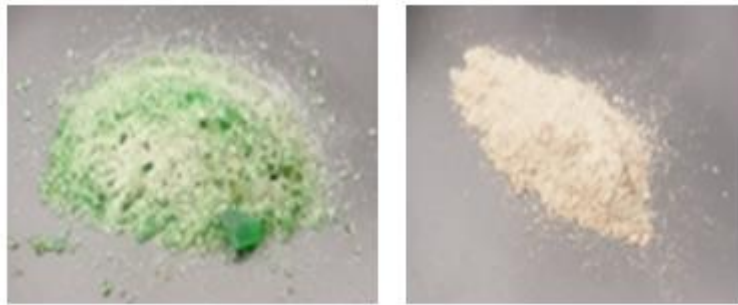
Figura 27 - Resultado da peneiração após 10 ciclos na máquina de Los Angeles.
