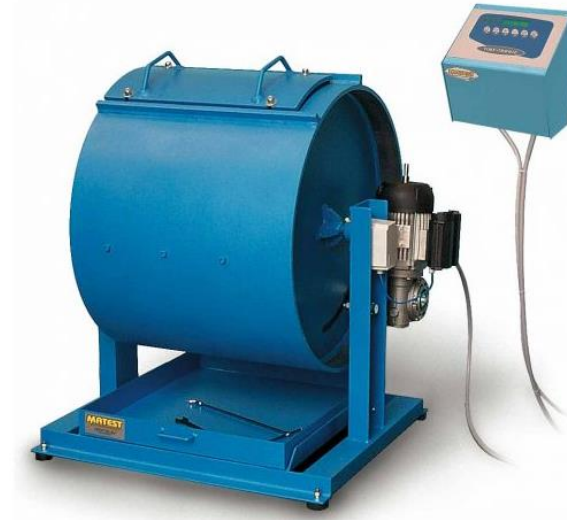
Figura 26 - Máquina de desgaste de Los Angeles utilizada durante a pesquisa.
