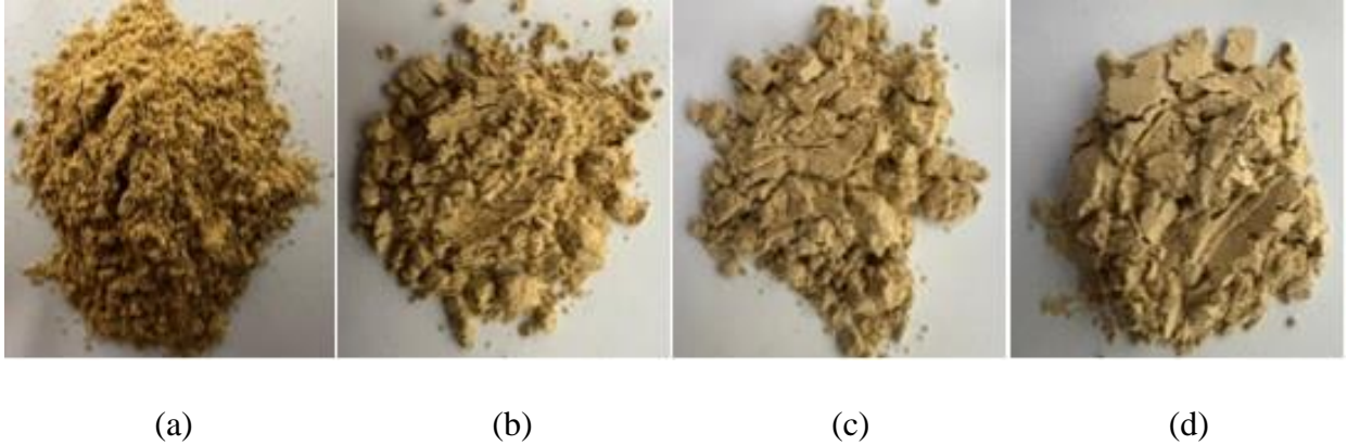
Figura 32 - Resultado da peneiração após 10 (a), 20 (b), 30 (c) e 40 (d) ciclos do vidro âmbar, respetivamente, na máquina de Los Angeles.
