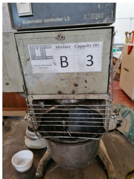
Figura 43 - Misturadora do LMC utilizada durante a pesquisa.
