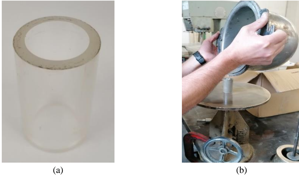
Figura 40 - Ensaio de trabalhabilidade: (a) Molde adaptado; (b) Inserção da argamassa no molde.
