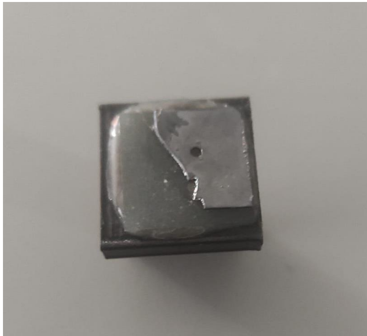
Figura 4.16 - Rotura da ligação vidro-silício efetuada a 250°C para uma força de 270N.
