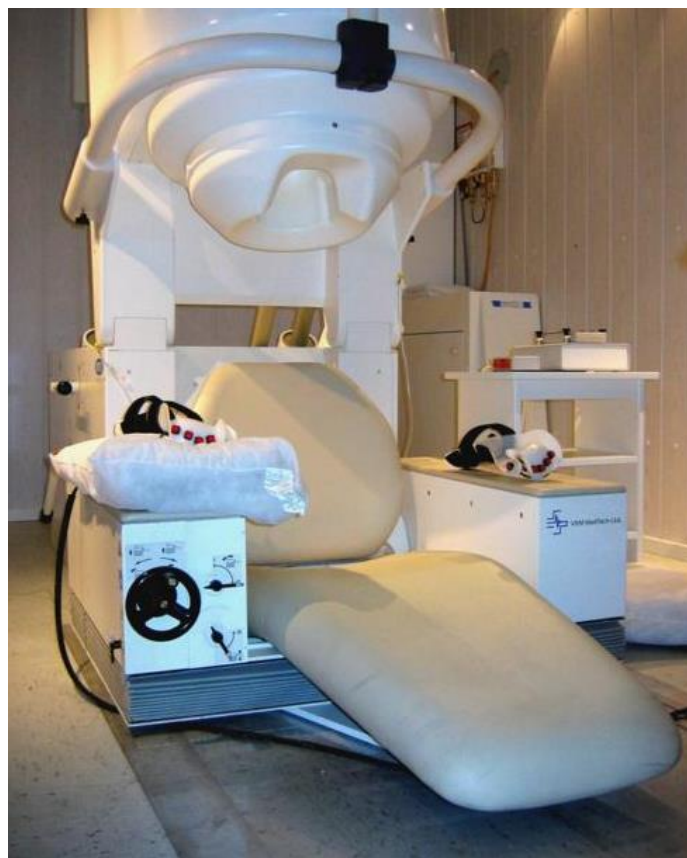
Figura 1.2 - Dispositivo MEG convencional baseado no uso de SQUIDs.
