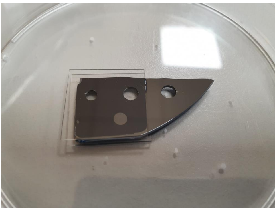
Figura 4.26 - Células de vapor após realização do segundo anodic bonding em vácuo.
