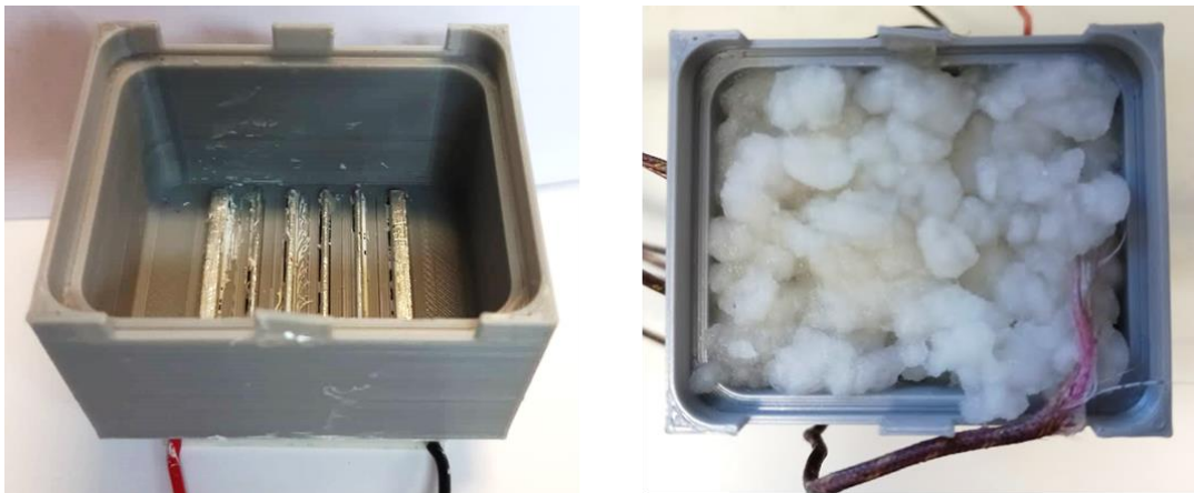
Figura 21 - À esquerda, o fantoma com o peltier acoplado, à direita, o fantoma com o polímero no interior.
