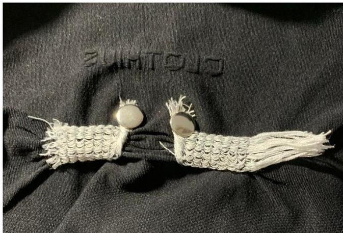
*Figura 31. Posicionamento das molas nos eléctrodos com o fio Bekintex*
