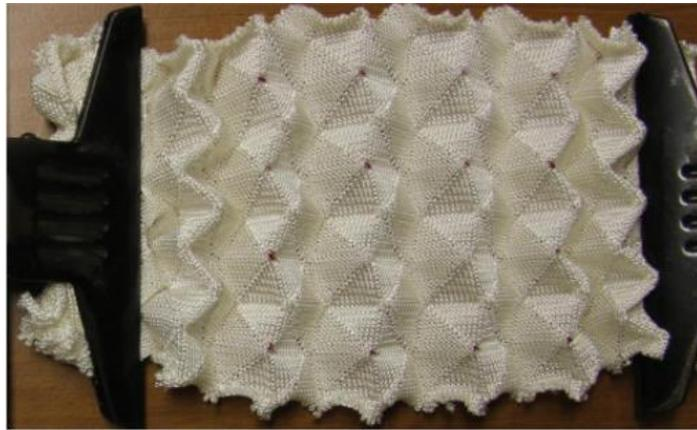
*Figura 17. Exemplo de estrutura de malha 3D (Kumar e Thakur, 2017)*
