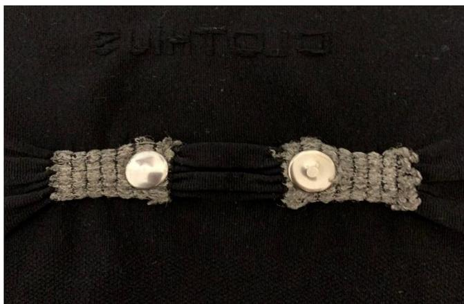
*Figura 32. Posicionamento das molas nos eléctrodos com o fio Elitex*
