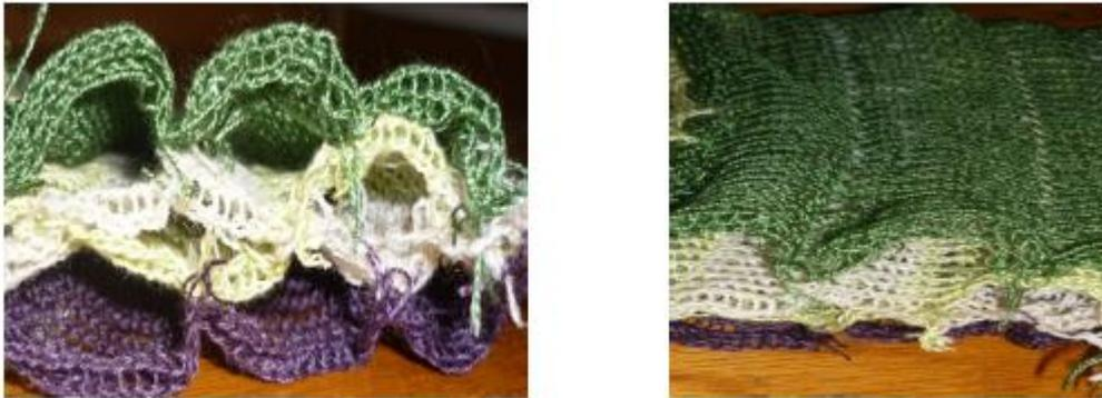
Figura 16. Estrutura sanduíche (Ionesi et al., 2010)
