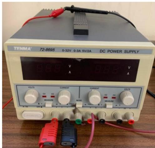
Figura 20. Fonte de alimentação DC Power Supply TENMA 72-8695
