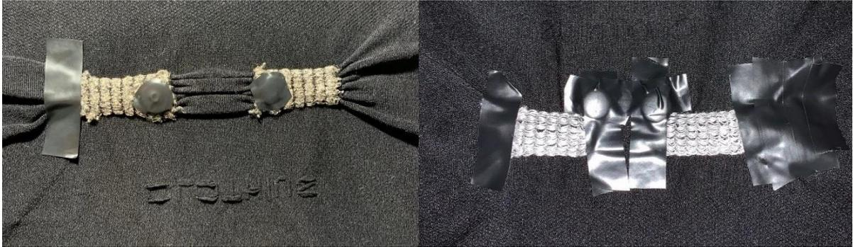
Figura 33. Eléttodos com os fios Bekintex e Elitex isolados com fita isoladora
