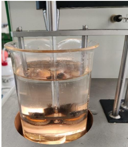
Figura 99: Fotografia do início do ensaio do ponto de amolecimento.
