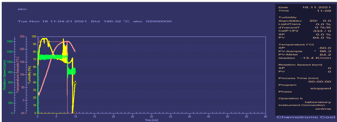
Figura 16: Gráfico dos resultados experimentais obtidos no ensaio do ponto de turvação. As curvas a amarelo, rosa e verde correspondem à variação da turvação, em %, temperatura, em °C, e velocidade de agitação, em rotações por minuto (rpm), respetivamente, ao longo do tempo.
