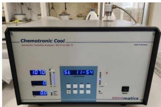
Figura 100: Fotografia do equipamento Chemotronic Cool utilizado no ensaio do ponto de turvação.
