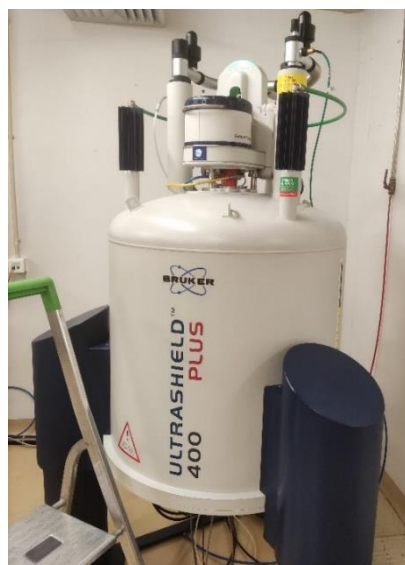
Figura 43: Fotografia do espectrómetro de RMN.
