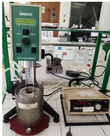
Figura 13: Fotografia do equipamento utilizado para determinar a viscosidade.
