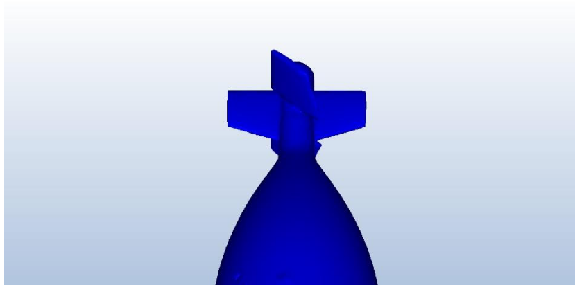
Figura 3.29 – Inclinação do leme a 45 °.
