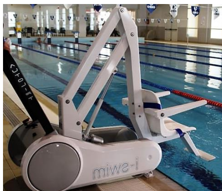
Figura 73 - Aparelho utilizado para colocar o nadador condicionado na água
