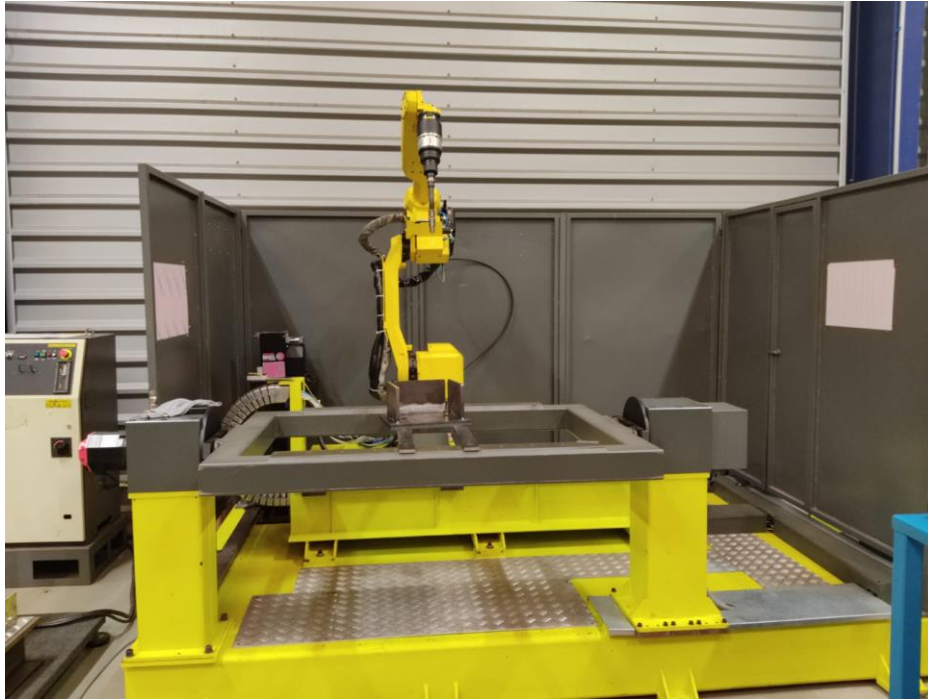
Figura 4.6 - Célula de soldadura do robô FANUC da Motofil
