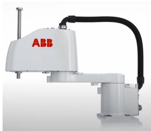
Figura 3.5 - Robô de configuração SCARA [13]
