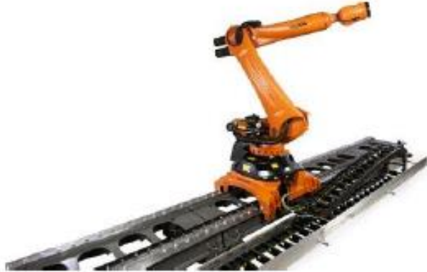
Figura 3.6 - Eixo externo dedicado à translação de um robô [18]
