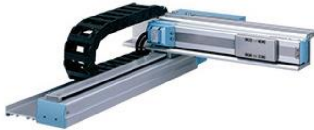
Figura 3.1 - Robô de configuração cartesiana [9]
