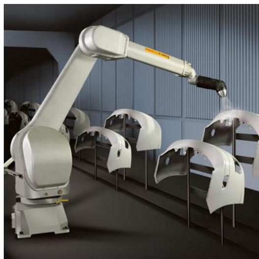
Figura 6 - Exemplo de braço robótico em processo de pintura (FANUC, s.d.).
