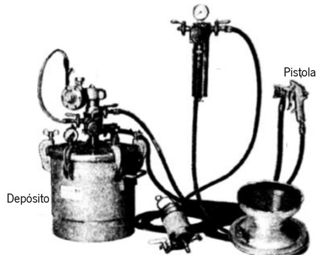
Figura 11 -Pistola convencional com depósito não acoplado (adaptado de (Sintra, 2017)).
