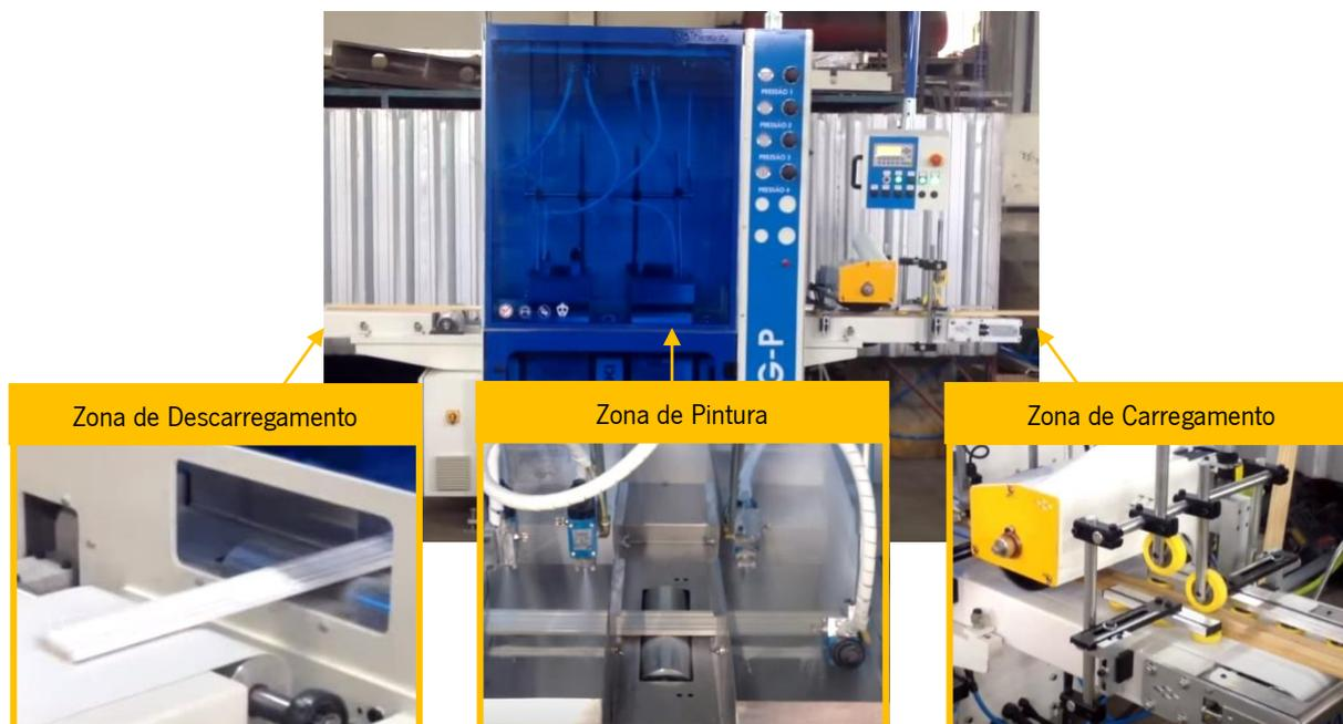
Figura 45 - Máquina de pintura de perfis (adaptado de (Gaidzinski, s.d.)).
