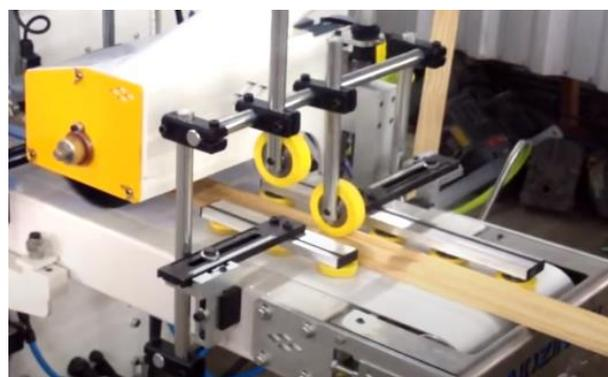
Figura 27 - Exemplo de utilização de calhas de guiamento para pintura de perfis (adaptado de (Gaidzinski, s.d.)).
