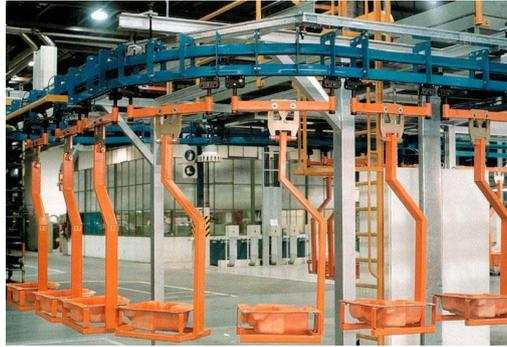
Figura 30 - Exemplo de transportador de corrente invertido (ACCI, s.d.).
