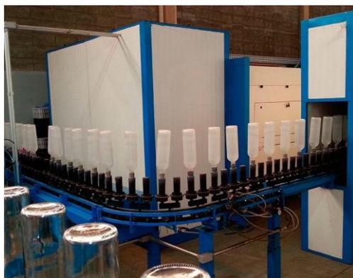
Figura 29 - Exemplo de transportador de corrente (ACCI, s.d.).
