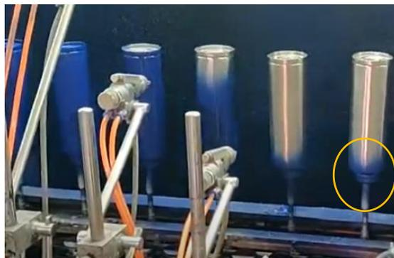
Figura 24 - Método de fixação de garrafas numa linha de pintura automática (Mali, 2019).
