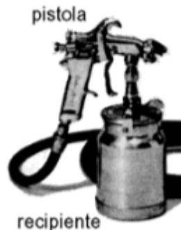
Figura 10 - -Exemplo de pistola convencional (adaptado de (Sintra, 2017)).
