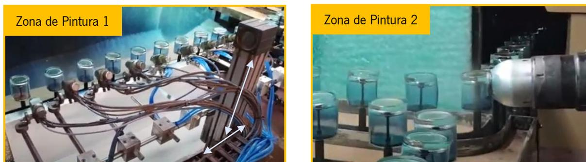
Figura 47 - Máquina de pintura automática de copos (adaptado de (ELSISAN, s.d.)).
