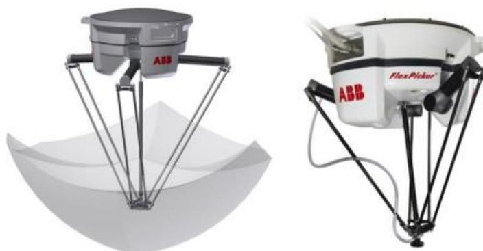
Figura 40 - Robô Paralelo: à esquerda o volume de trabalho e à direita a estrutura (Anjos, 2018).
