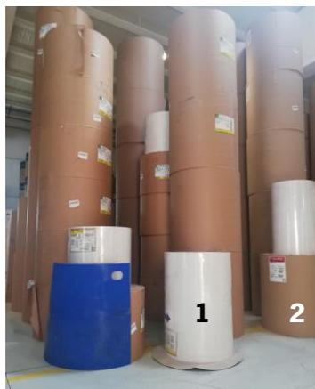
*Figura 23 - Exemplificação de bobines fora das marcações*
