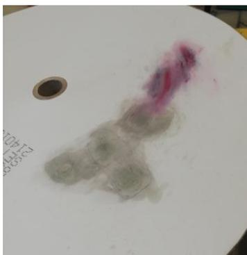
*Figura 20 - Bobine danificada devido a humidade*
