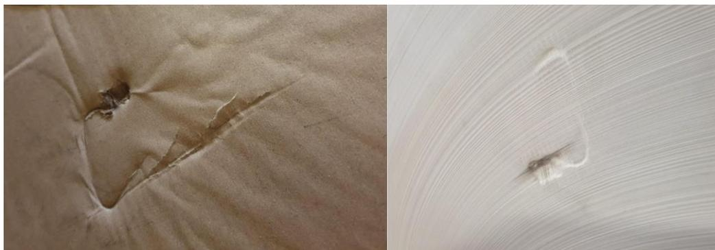
*Figura 19 - Bobine danificada devido a objeto estranho*
