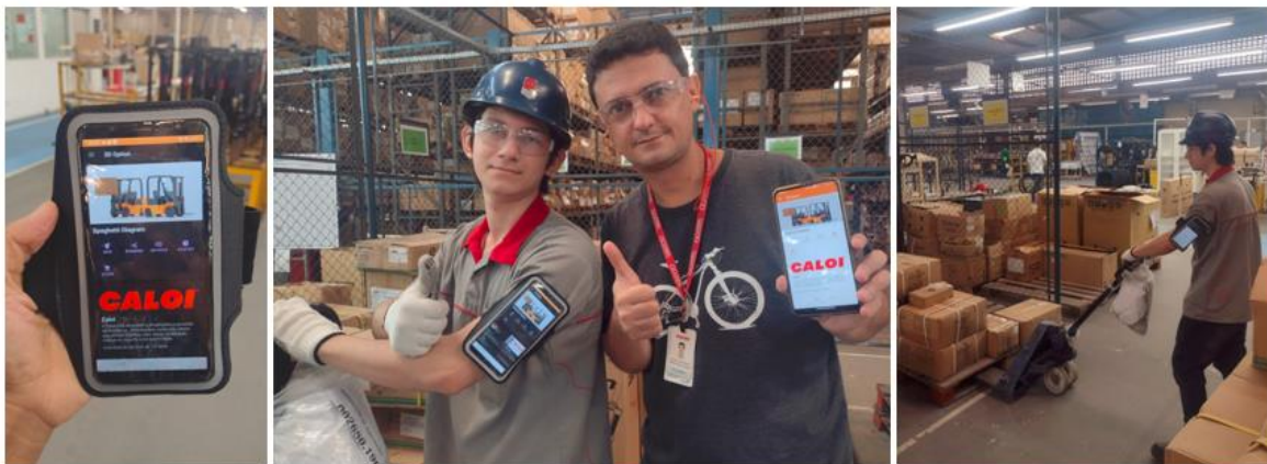
Figura 27- Braçadeira de celular e o uso do Spaghetti Diagram App na alimentação de materiais.
