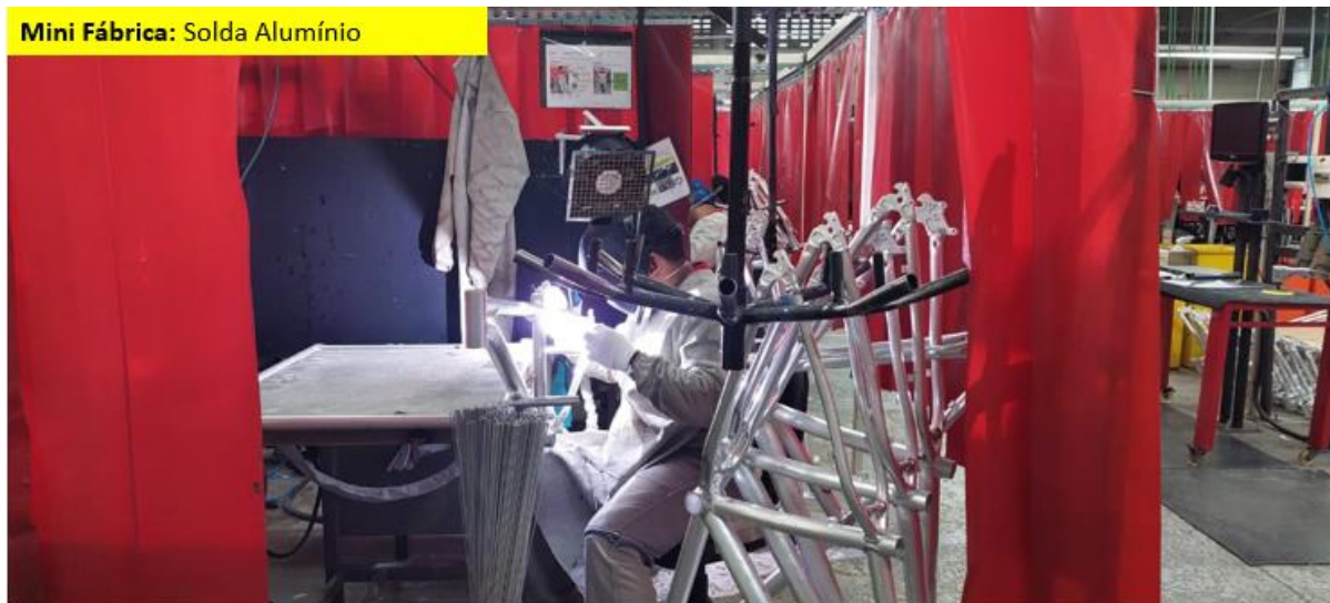
Figura 18- Processo de soldagem de quadros de bicicletas. (Autor, 2022)
