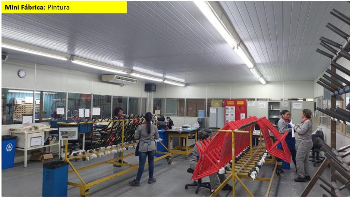
Figura 19- Processo de adesivagem clear coat de quadros de bicicletas. (Autor, 2022)
