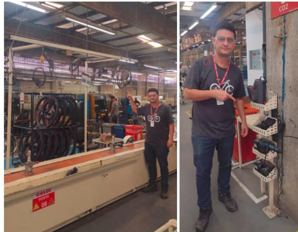
Figura 45- Instalação de balancim para parafusadeiras pneumáticas, e criação de suporte para carregamento de baterias na linha de montagem de bicicletas 4.
