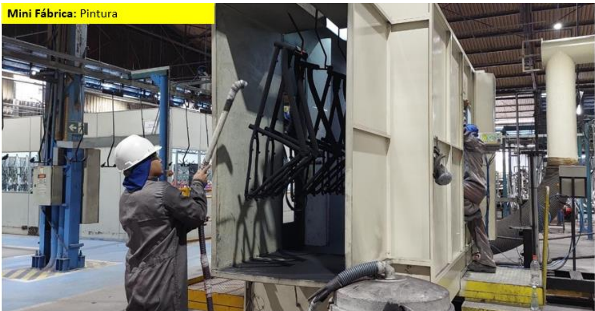
Figura 20- Processo de Pintura Eletrostática Pó em quadros de bicicletas. (Autor, 2022)
