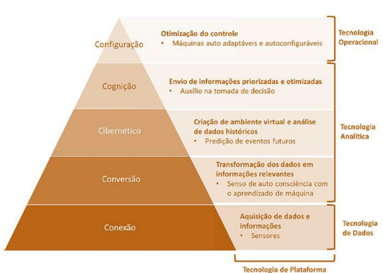
Figura 5- Estrutura de um Sistema Ciber-Físico. Adaptado LEE , 2008.
