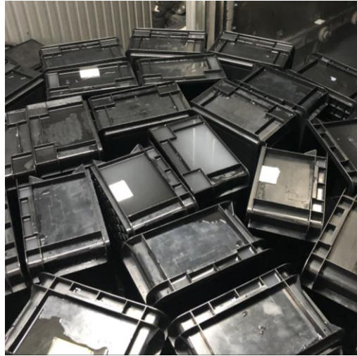
Figura 27: Caixas com água acumulada no topo
