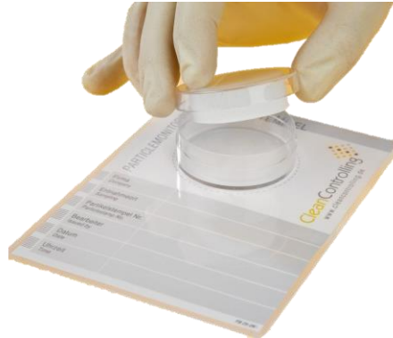
Figura 8: Teste de Carimbo de partículas
