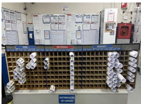
Figura 26 - Estrutura para colocação das listas de picking
