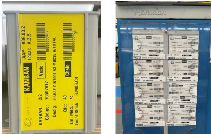
Figura 32 - Caixa kanban (à esquerda) e cartões kanban (à direita)
