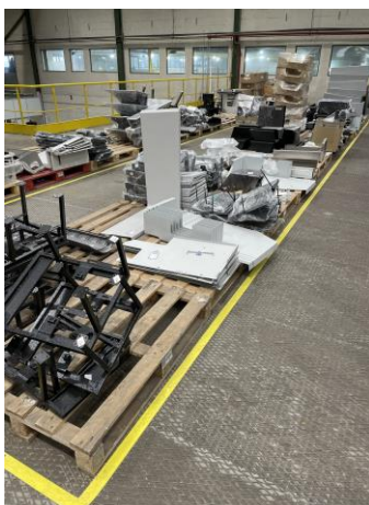
Figura 36 - Falta de aproveitamento do espaço de armazenagem disponível em altura
