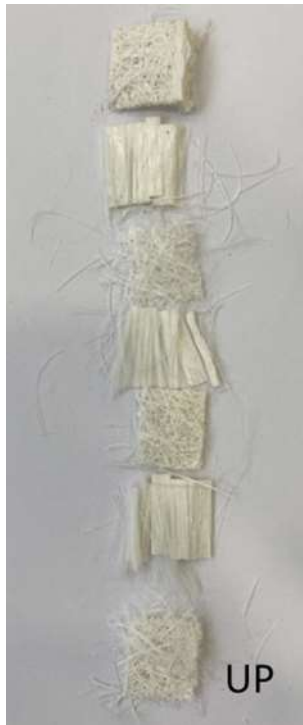
Figura 32 - Camadas de fibras de vidro que compõem o compósito com resina UP
