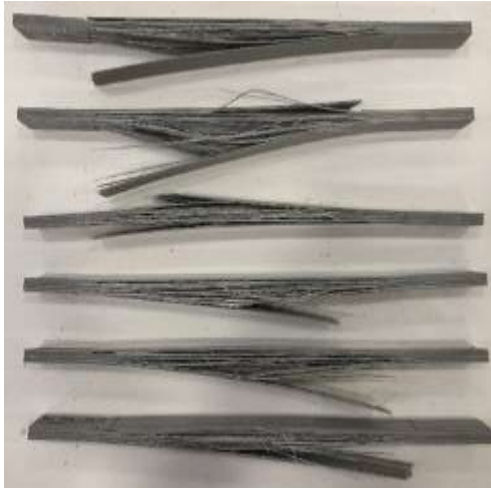
Figura 133 - Modos de rotura dos provetes nos ensaios de tração 0° W60 D UP
