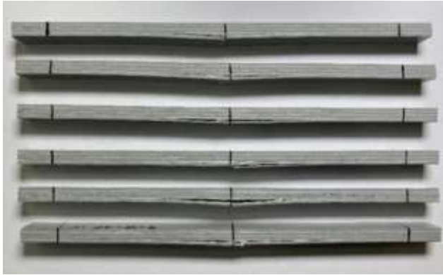
Figura 76 - Modos de rotura dos provetes de referência nos ensaios de flexão UP
