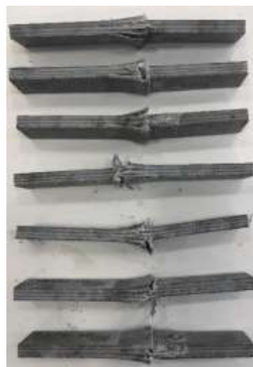
Figura 188 - Modos de rotura dos provetes nos ensaios de compressão T20 VE
