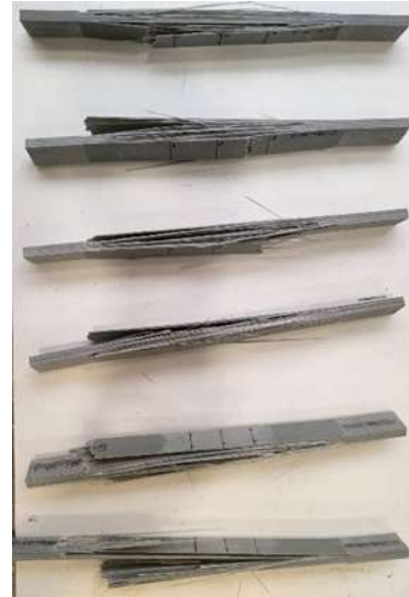
Figura 146 - Modos de rotura dos provetes nos ensaios de tração 0° T60 VE
