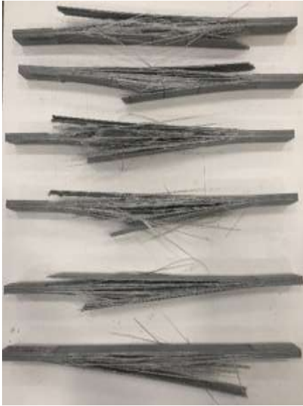
Figura 142 - Modos de rotura dos provetes nos ensaios de tração 0° T40 UP
