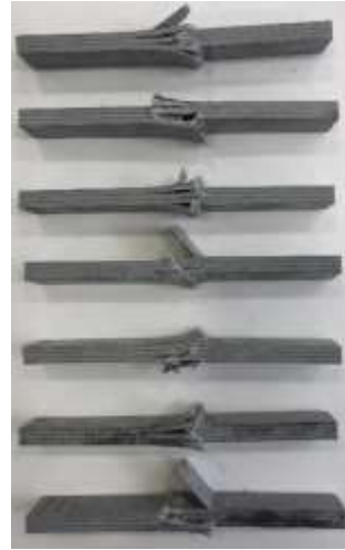
Figura 182 - Modos de rotura dos provetes nos ensaios de compressão W60 D VE
