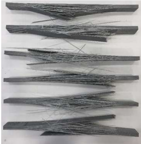
Figura 139 - Modos de rotura dos provetes nos ensaios de tração 0° T20 UP
