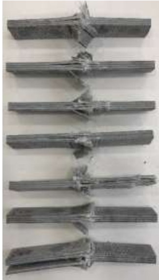
Figura 190 - Modos de rotura dos provetes nos ensaios de compressão T40 UP
