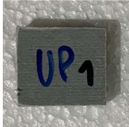
Figura 5 - Provete UP utilizado no ensaio de calcinação
