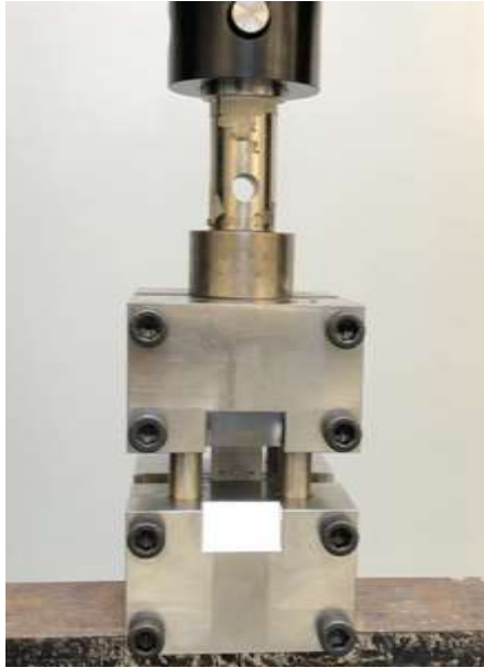
Figura 17 – Máquina MTS para a realização do ensaio de compressão (apenas para a determinação do módulo de elasticidade)
