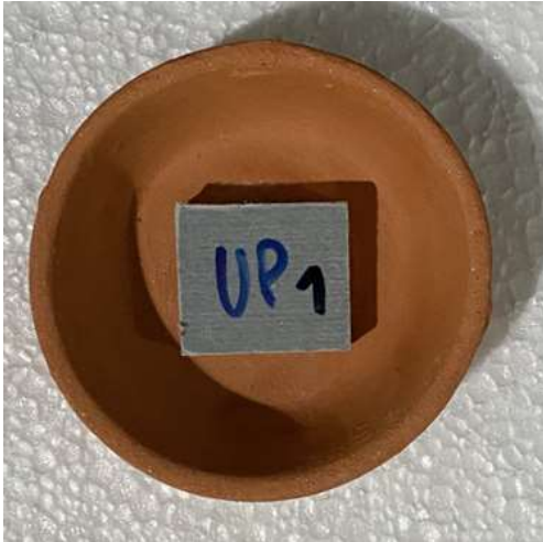
Figura 4 - Recipiente de barro com provete de UP no ensaio de calcinação
