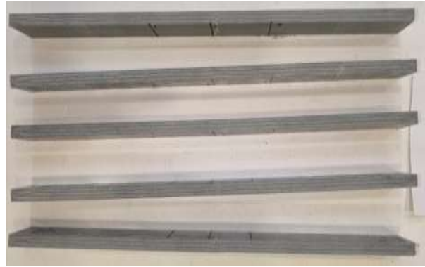
Figura 155 - Modos de rotura dos provetes nos ensaios de tração 90° T-15 VE
