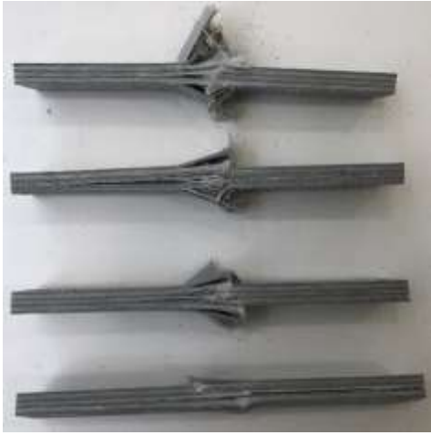
Figura 184 - Modos de rotura dos provetes nos ensaios de compressão T-15 UP
