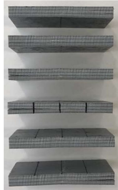
Figura 122 - Modos de rotura dos provetes nos ensaios de corte interlaminar T20 UP
