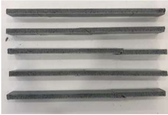
Figura 148 - Modos de rotura dos provetes nos ensaios de tração 90° W60 S UP
