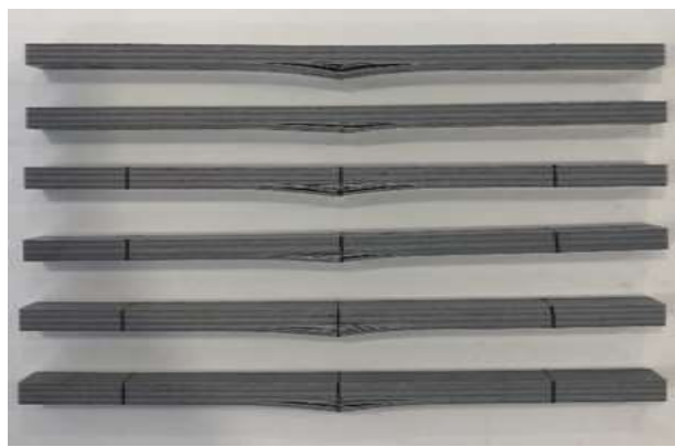
Figura 95 - Modos de rotura dos provetes nos ensaios de flexão W60 S VE
