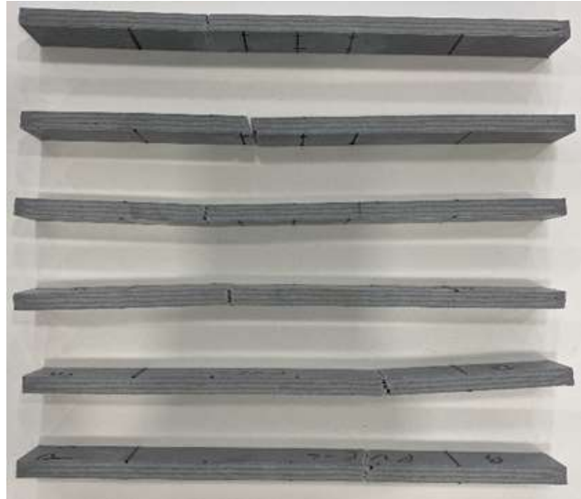
Figura 86 - Modos de rotura dos provetes de referência nos ensaios de tração 90° VE
