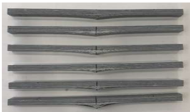
Figura 100 - Modos de rotura dos provetes nos ensaios de flexão T-15 UP
