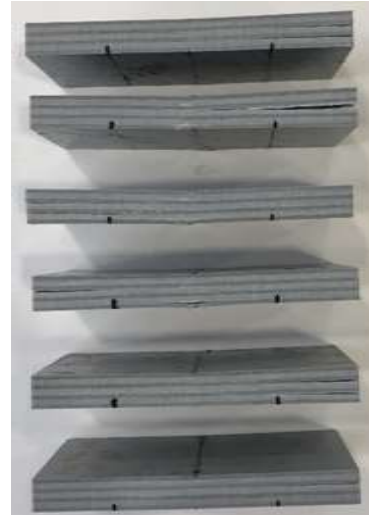
Figura 125 - Modos de rotura dos provetes nos ensaios de corte interlaminar T40 UP
