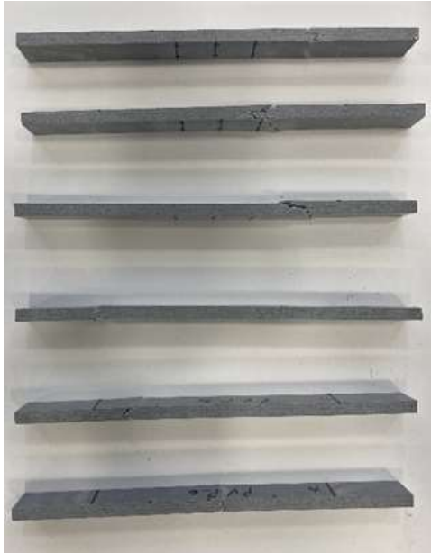
Figura 85 - Modos de rotura dos provetes de referência nos ensaios de tração 90° UP
