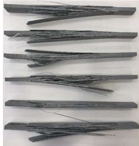
Figura 140 - Modos de rotura dos provetes nos ensaios de tração 0° T20 VE
