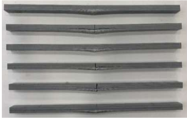
Figura 110 - Modos de rotura dos provetes nos ensaios de flexão T60 VE
