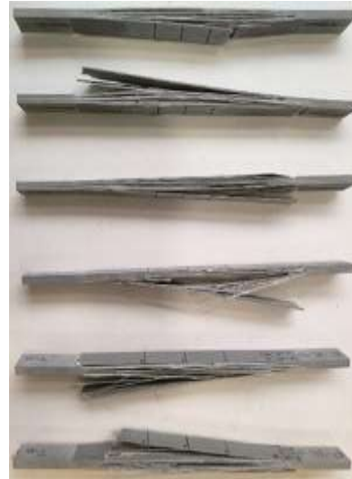
Figura 137 - Modos de rotura dos provetes nos ensaios de tração 0° T-15 VE
