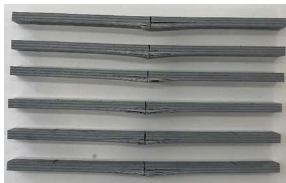
Figura 101 - Modos de rotura dos provetes nos ensaios de T-15 VE
