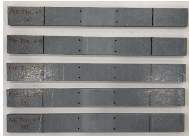
Figura 161 - Modos de rotura dos provetes nos ensaios de tração 90° T40 VE
