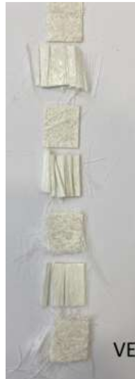
Figura 33 - Camadas de fibras de vidro que compõem o compósito com resina VE
