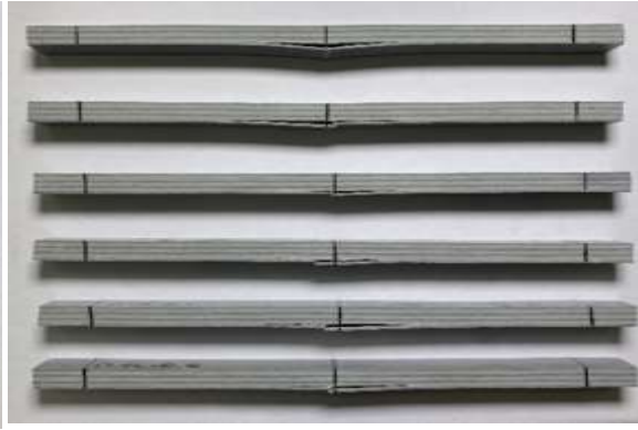
Figura 77 - Modos de rotura dos provetes de referência nos ensaios de flexão VE
