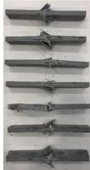
Figura 191 - Modos de rotura dos provetes nos ensaios de compressão T40 VE
