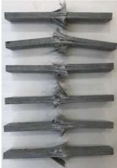
Figura 193 - Modos de rotura dos provetes nos ensaios de compressão T60 UP
