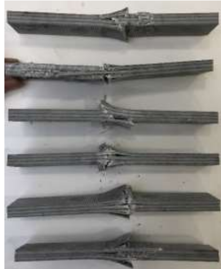
Figura 194 - Modos de rotura dos provetes nos ensaios de compressão T60 VE
