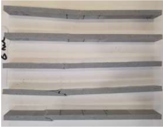
Figura 154 - Modos de rotura dos provetes nos ensaios de tração 90° T-15 UP
