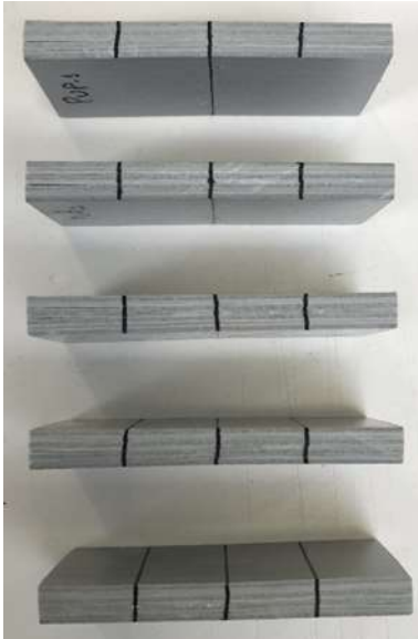
Figura 79 - Modos de rotura dos provetes de referência nos ensaios de corte interlaminar UP
