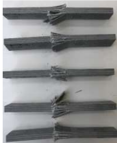
Figura 185 - Modos de rotura dos provetes nos ensaios de compressão T-15 VE
