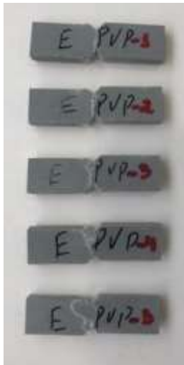
Figura 88 - Modos de rotura dos provetes de referência nos ensaios de corte no plano UP
