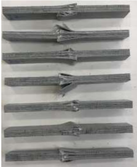
Figura 178 - Modos de rotura dos provetes nos ensaios de compressão W60 S UP
