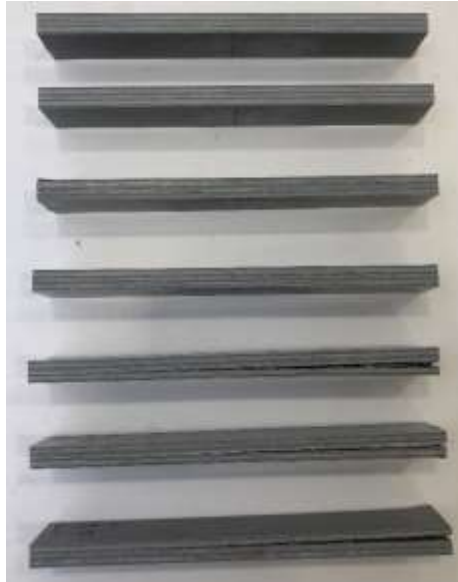
Figura 48 - Provetes UP para ensaio de compressão inválidos
