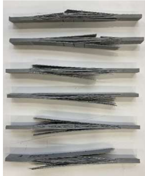
Figura 83 - Modos de rotura dos provetes de referência nos ensaios de tração 0° VE
