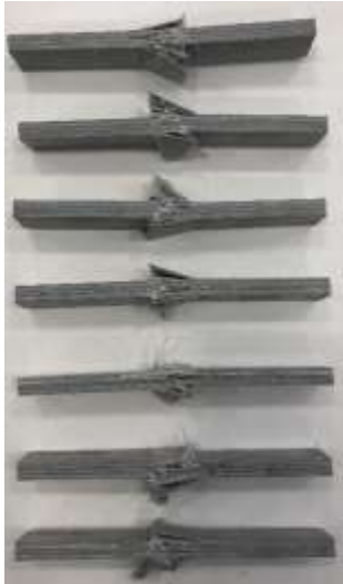
Figura 181 - Modos de rotura dos provetes nos ensaios de compressão W60 D UP
