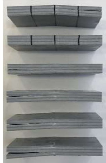
Figura 119 - Modos de rotura dos provetes nos ensaios de corte interlaminar T-15 VE
