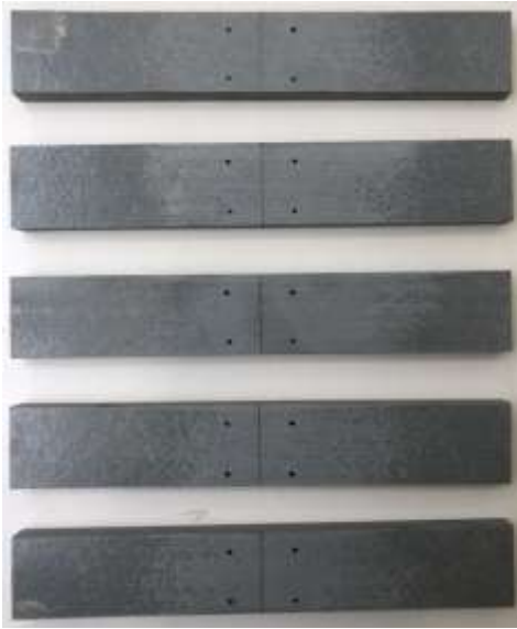
Figura 15 - Marcação dos pontos do ensaio de compressão na zona central para medição das extensões
