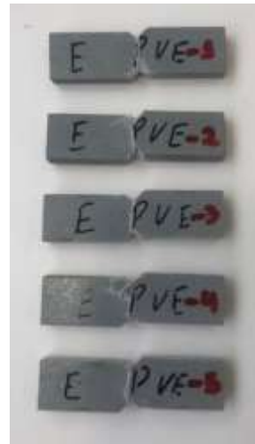
Figura 89 - Modos de rotura dos provetes de referência nos ensaios de corte no plano VE
