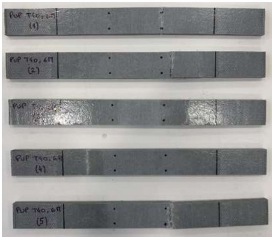
Figura 160 - Modos de rotura dos provetes nos ensaios de tração 90° T40 UP
