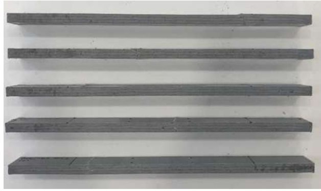
Figura 149 - Modos de rotura dos provetes nos ensaios de tração 90° W60 S VE
