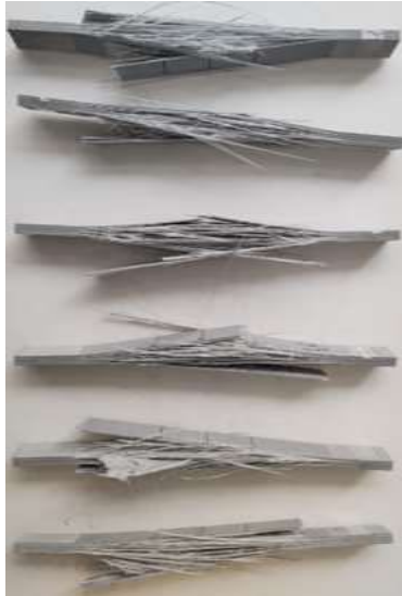
Figura 145 - Modos de rotura dos provetes nos ensaios de tração 0° T60 UP
