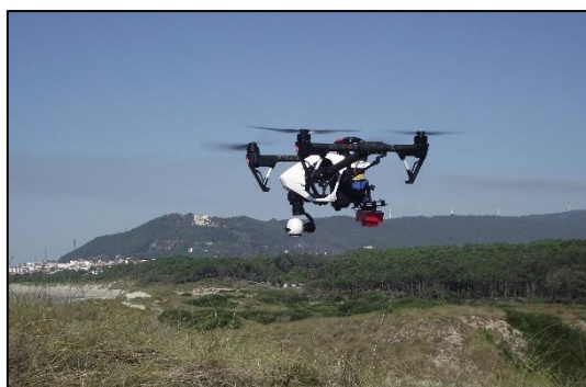
Figura 10 - VANT Dji Inspire 1 com a câmara multiespectral Micasense RedEdge M acoplada a sobrevoar a área de estudo (Praia do Rodanho)
