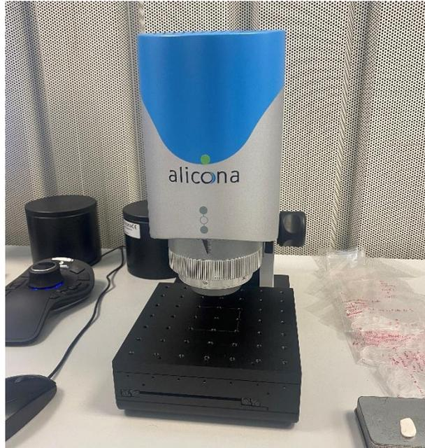
**Figura 17** - Equipamento de medição de rugosidade.
