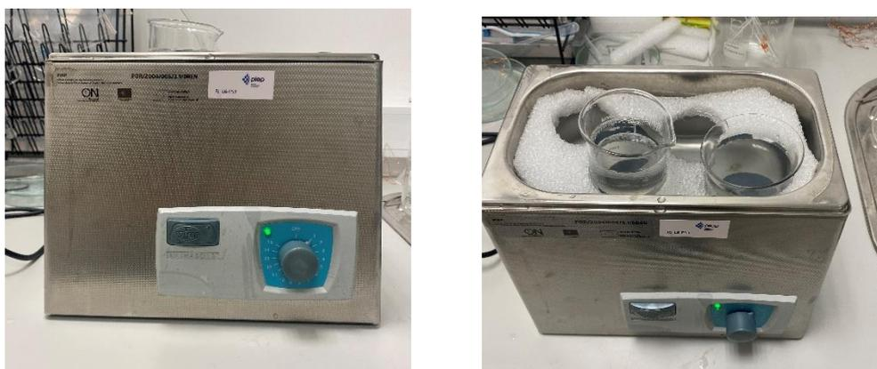
**Figura 15** - Equipamento de limpeza por ultrassons.
