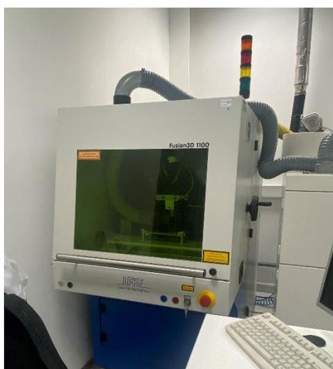
**Figura 13** - Equipamento com laser Nd:YAG.
