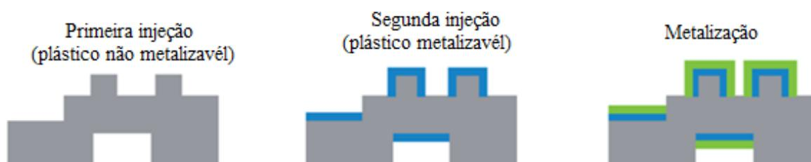
**Figura 3** - Processo de produção de um MID utilizando o processo de Moldação por bi-injeção. Adaptado de: [2]
