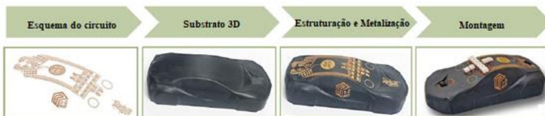
**Figura 1-** Sequência de processo de fabrico MID. Adaptada de: [2]
