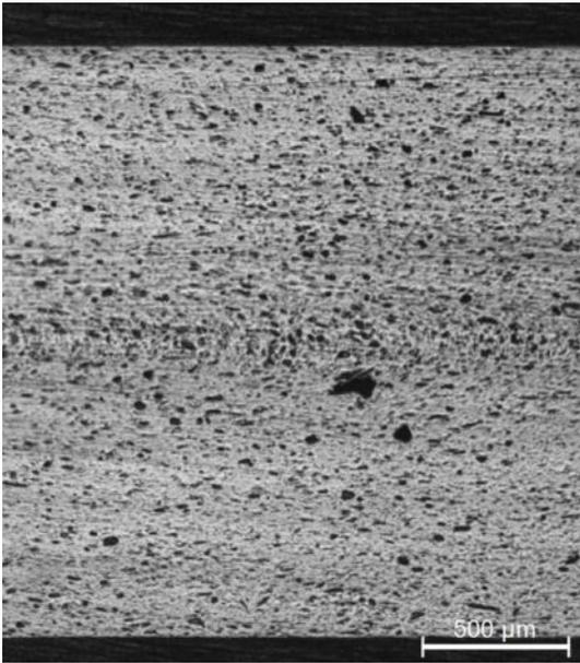
**Exp.5:**  $T_f = 330^\circ\text{C}$ ;  $T_m = 140^\circ\text{C}$ ;  $V_i = 20\text{ mm/s}$
