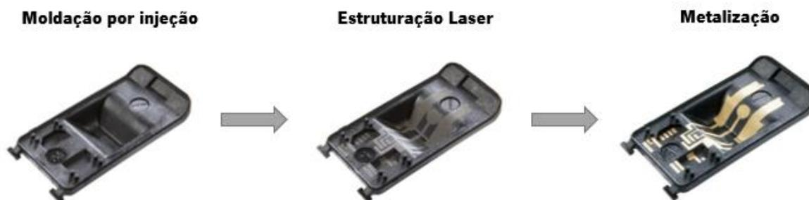
**Figura 5** - Sequência do Processo LDS [23].
