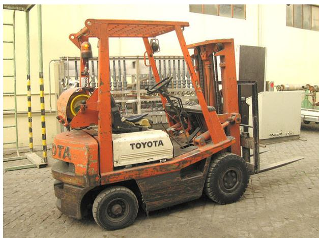
**Figura 7.2** – Empilhador com sirene identificadora de marcha-atrás.
