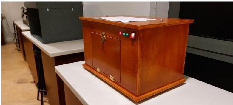
Figura 3.4 Caixa de iluminação fechada com as lâmpadas emissoras de UVC em funcionamento.
