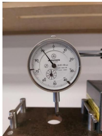
Figura 3.13 Relógio comparador. Escala utilizada no equipamento.
