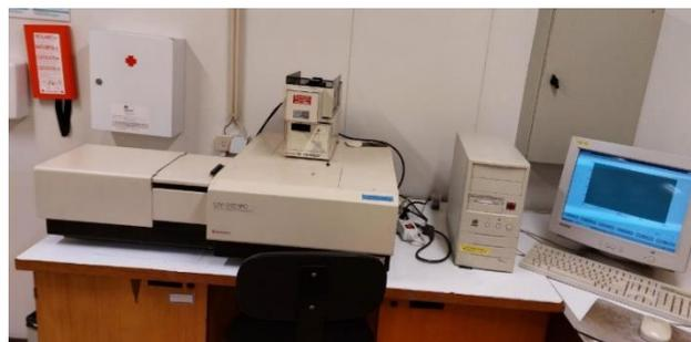
Figura 3.3 Espectrofotómetro de bancada utilizado, o modelo UVPC 3101 PC UV-VIS-NIR da Shimadzu, Kyoto, Japão.
