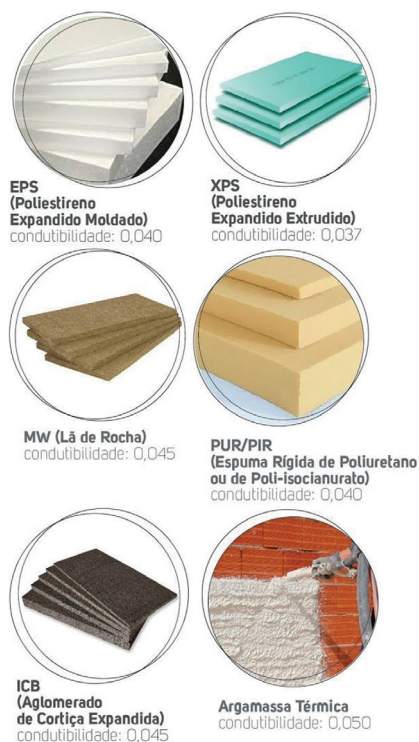
Figura 28 Alguns exemplos de soluções de isolamento disponíveis no mercado (fonte: ADENE).
