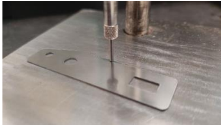
Figura 42 - Fotografia do método de medição da altura de rebarba através de um comparador.
