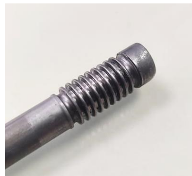
Figura 75 - Geometria obtida na 2ª operação de forjamento a frio.
