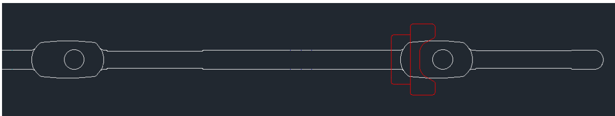
Figura 77 – Vista de cima do posicionamento relativo dos punções de corte que destacam a peça à saída da ferramenta.
