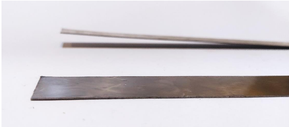
Figura 51 – Extremidades de duas amostras da matéria-prima utilizada, uma delas endireitada (situada à frente) e outra ainda no estado inicial (situada atrás).
