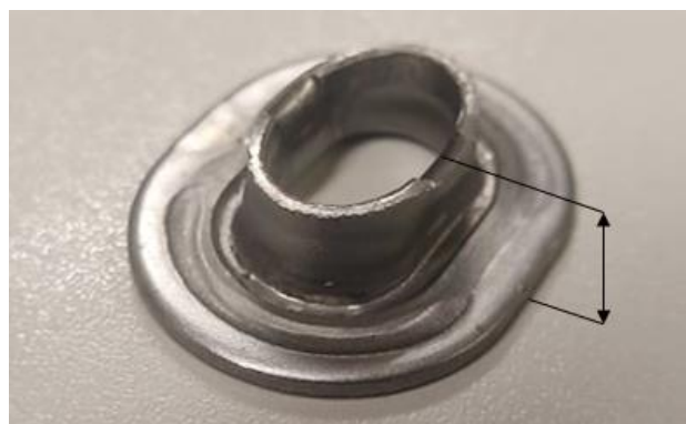
Figura 59 – Cota não conforme.
