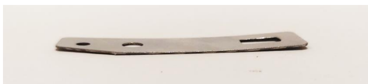
Figura 48 - Exemplo de uma peça produzida com defeitos na planeza.
