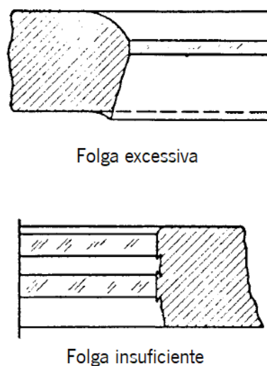
Figura 21 – Ilustração exemplificativa dos efeitos de um incorreto dimensionamento da folga entre punções e matrizes de corte [17].
