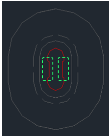
Figura 56 – Vista superior da localização do punção de corte do furo da peça (a vermelho) em relação à mesma. A traço interrompido verde está destacado o perfil de excesso de material que será posteriormente dobrado.
