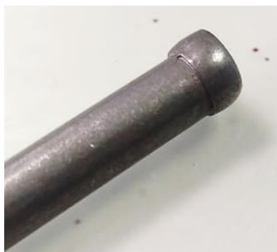
Figura 76 - Geometria obtida na 1ª operação de forjamento a frio.
