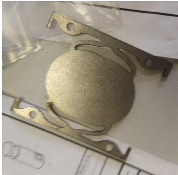
Figura 67 - Nova geometria da rede da banda da ferramenta “Spacer”.
