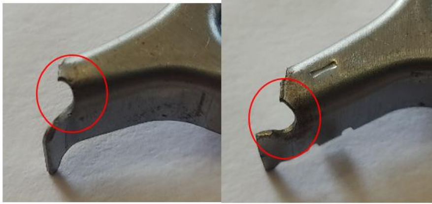
Figura 86 - Pormenor geométrico presente nas outras extremidades da peça.
