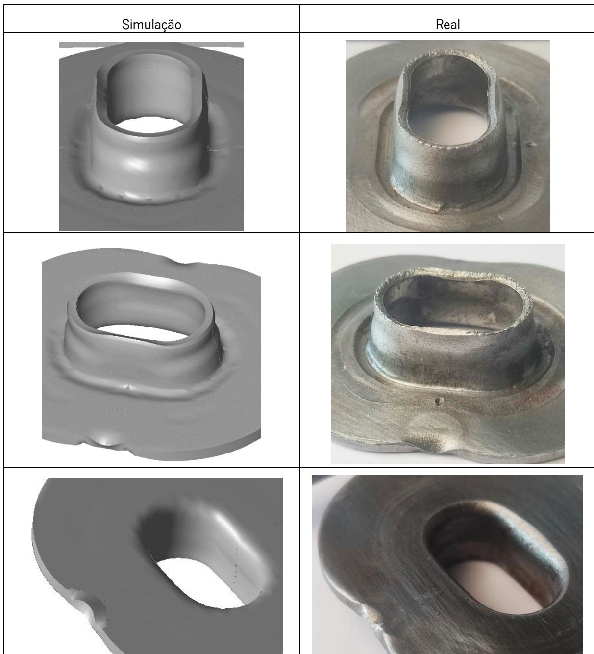
Figura 115 – Comparação de pormenores geométricos entre a malha obtida a partir das simulações e a peça real.
