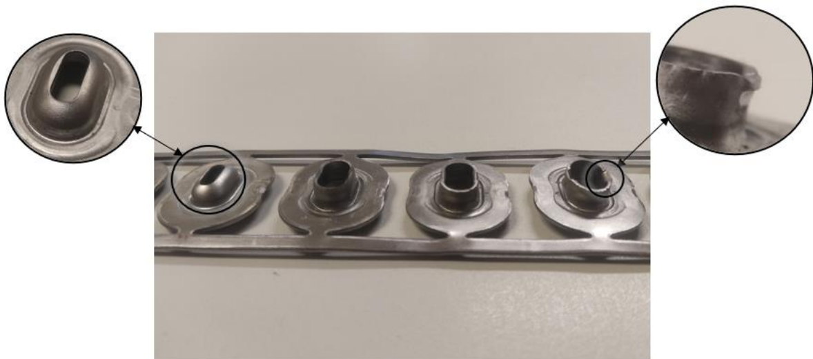
Figura 58 - Fotografia de quatro estágios da sequência de estampagem idealizada.
