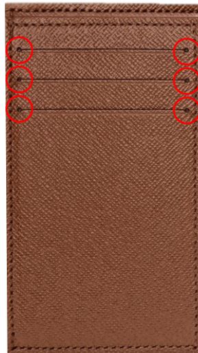
Figura 39 - Zonas suscetíveis a maior desgaste no poche-cc.
