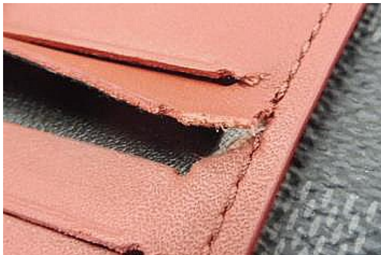
Figura 52 - Falha de resistência mais severa numa peça de pocche-cc.
