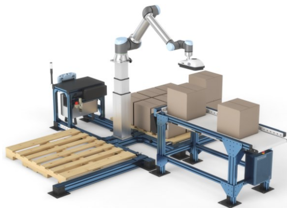
Figura 13 - Cobot a desempenhar uma tarefa de paletização com o auxílio de um tapete rolante.
