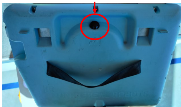
Figura 68 - Identificação e localização do botão “FreeDrive” no ecrã tátil.
