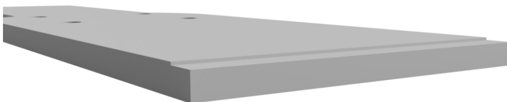
Figura 35 - Degrau nas extremidades do end-effector para efeitos de alinhamento e resistência.
