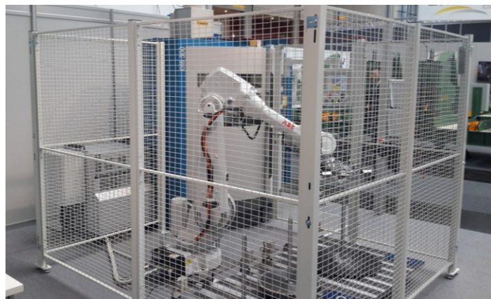
Figura 8 - Exemplo de aplicação de um manipulador tradicional, enjaulado por motivos de segurança. [12]
