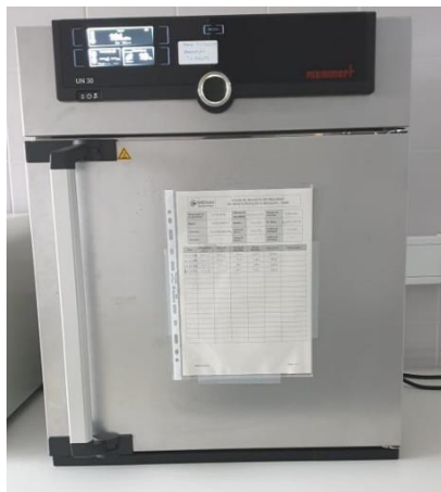
Figura 7- Estufa modelo Universal U, marca Memmert, utilizada neste trabalho para a análise aos sólidos.
