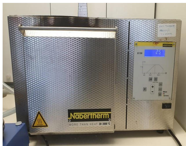
Figura 8-Mufla modelo L 1/12 - LT 40/12, marca Nabertherm, utilizada neste trabalho para a análise aos sólidos.
