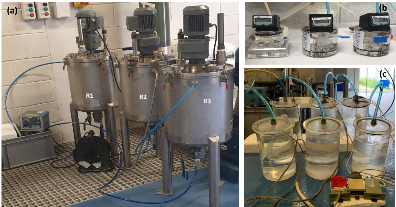
Figura 6-Instalação experimental dos três reatores e respetivo sistema de aquecimento (a), contadores de biogás “Ritter MilliGas counter” utilizados inicialmente (b) e contadores de biogás utilizados nos períodos 3 e 4 de operação (c)
