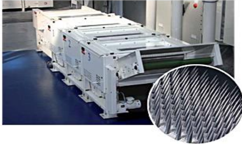
Figura 11 - Desfibradora modular ("Cadette") destinada a processar todo o tipo de desperdício (fiações, tricotagem, tecelagem, confeções e não-tecidos) desde 50 kg até 3000 kg/h (Laroche, 2019)
