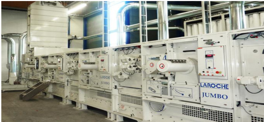
Figura 12 - Desfibradora ("Jumbo")destinada para produzir fibras regeneradas com todo o tipo de desperdícios têxteis (Laroche, 2019)
