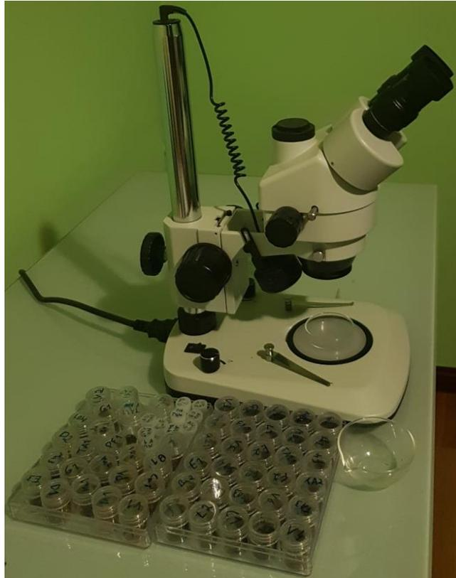
*Figura 15- Representação do microscópio usado na observação em MOLD assim como as respetivas amostras usadas, neste estudo, da recolha em "stream sediments".*
