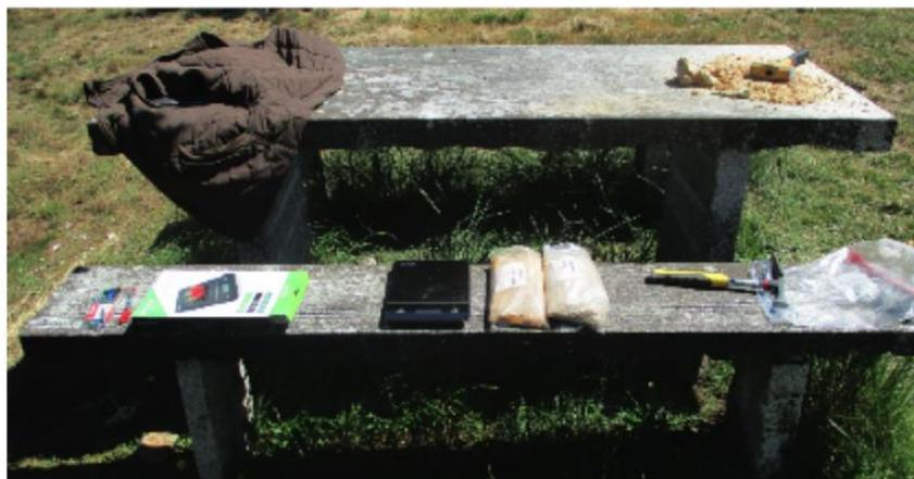
*Figura 10- Ilustração da cominuição e pesagem de amostras de rocha total (meios e equipamentos) sobre uma mesa granítica.*
