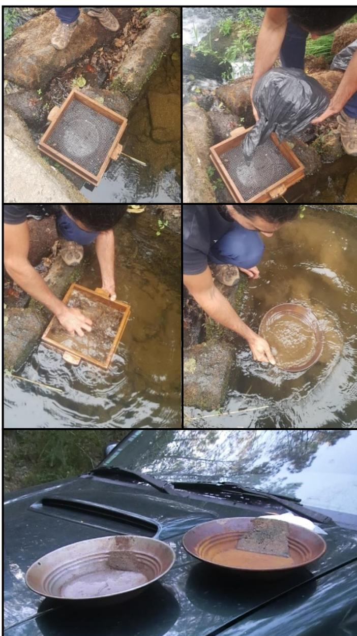
*Figura 14- Etapas de screening e bateamento de "stream sediments" e 2 exemplos de concentrados obtidos com estes procedimentos, com amostras muito ricas de minerais pesados.*
