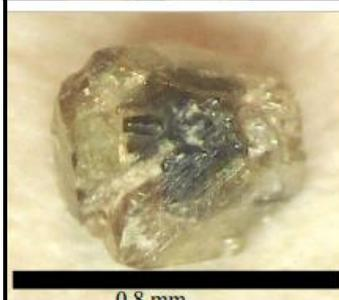
Inclusões de estibiotantalite em estibiomicrolite (núcleo) seguida de microlite (bordo) com zonamento da microlite hospedeira
