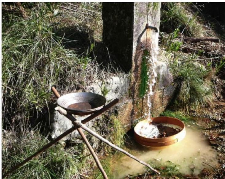
Figura 11- Meios para concentração em bateia de material friável aplito-pegmatítico - após crivagem de grandes volumes de amostra provenientes de canais transversais de grandes dimensões - uso de bateia “eastwing” de tipo “gold pan” convencional.
