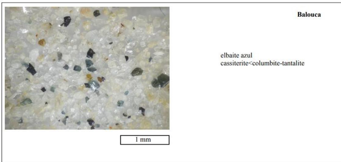
Figura 37- Estampa de extratos de minerais densos com assinatura LCT (turmalina colorida) obtido com bateia após trituração de amostra, observado em MOLD.
